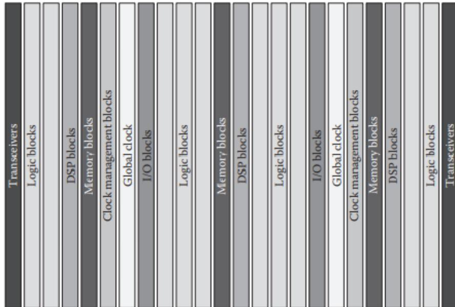
Fig. 3.2. Architettura basata su colonne [4].
