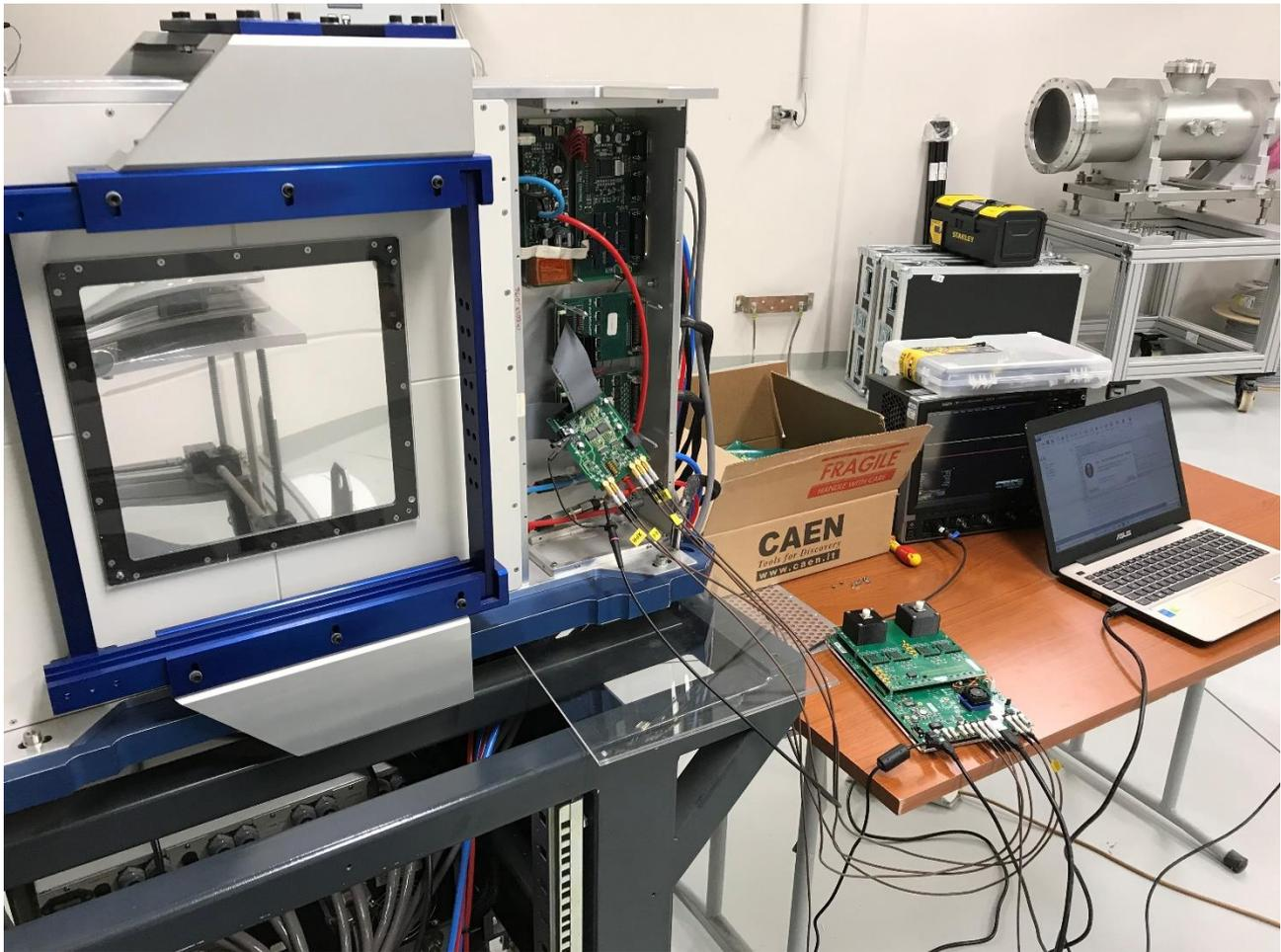
*Fig.10.8. Collegamento del sistema DT5550W/A55CIT4 + DD Low Int alla BOX1.*
