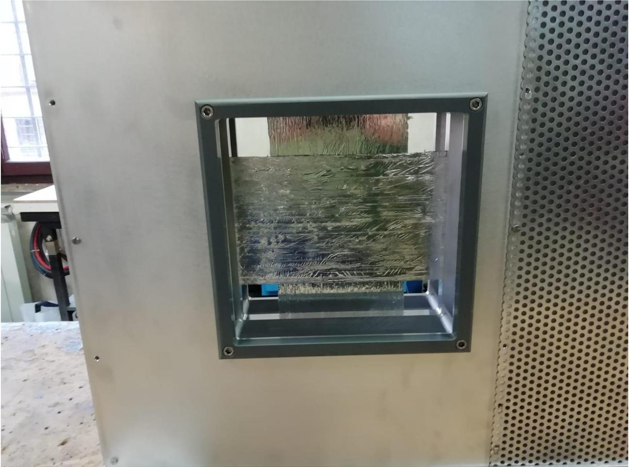
*Fig. 5.10. Visione ravvicinata delle fibre scintillanti.*
