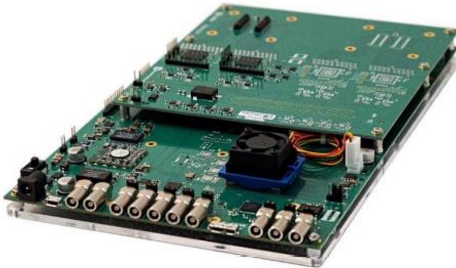
Fig. 6.1. Vista generale del sistema completo DT5550W con scheda piggyback A55PET2 montata superiormente [13].
