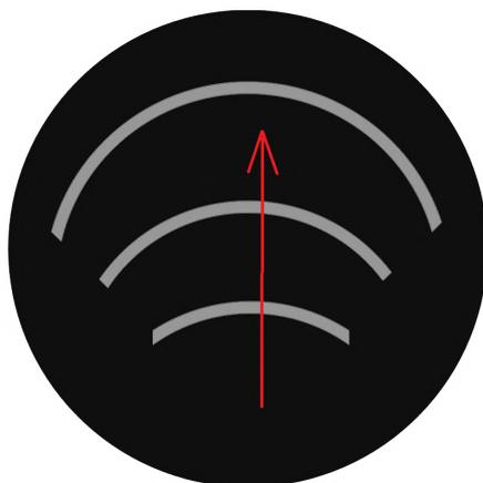
**Figura 6.15:** Direzione di prelievo delle misure di microdurezza lungo la cucitura di S3
