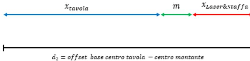
Figura 4.20: rappresentazione grafica del calcolo della posizione target “traslazione tavola”
