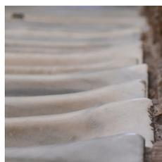
Valuta il comportamento del materiale in seguito ad un'azione di abrasione più o meno lunga. Il marmo ha una resistenza **"buona/elevata"**. Sicuramente risente dell'usura ma in tempi veramente estesi.
