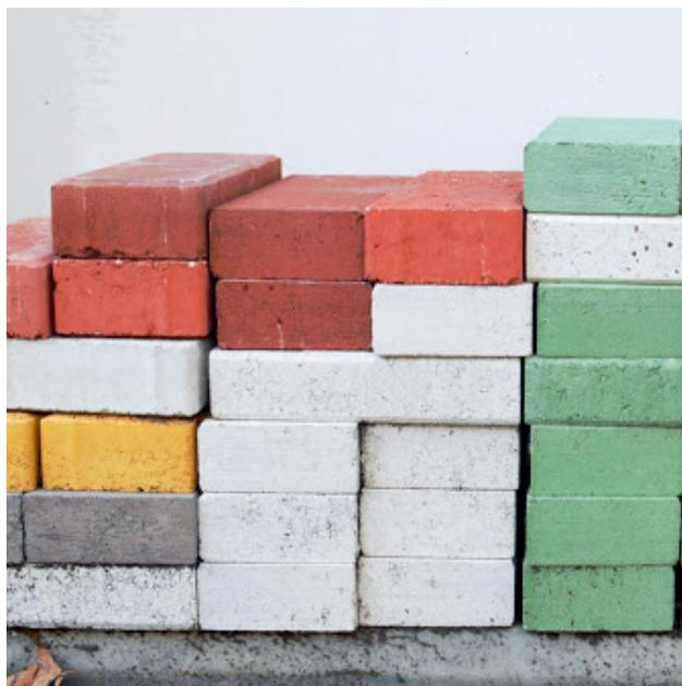
**Catalyst SRL** ([www.catalyst-group.it](http://www.catalyst-group.it)) è l'unica azienda che produce **elementi da costruzione UNI** (12cm)x(24cm)x(5,5cm) kg 3,650 circa, ottenuti per **compressione a freddo** (non impiega quindi sistemi di ventilazione per l'essiccazione) di:
