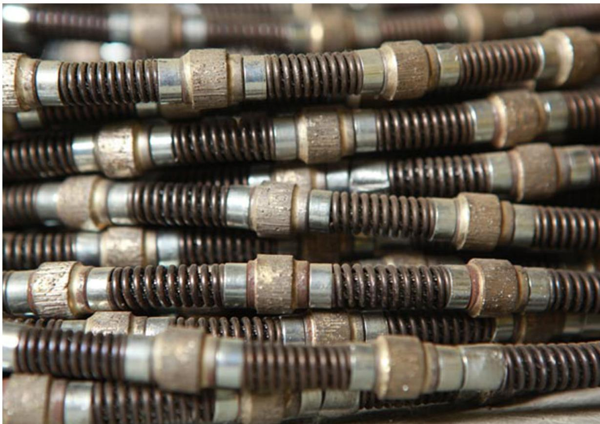
Le perline sono degli elementi di forma cilindrica, con diametro di 10 mm, che vengono inseriti sul filo diamantato come se fosse una collana.
