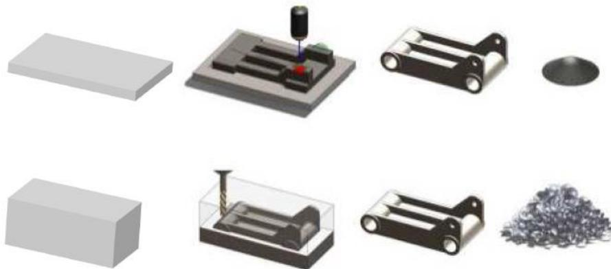
Figura 1. Processo di fabbricazione di un componente tramite tecnologie additive e sottrattive [3].
