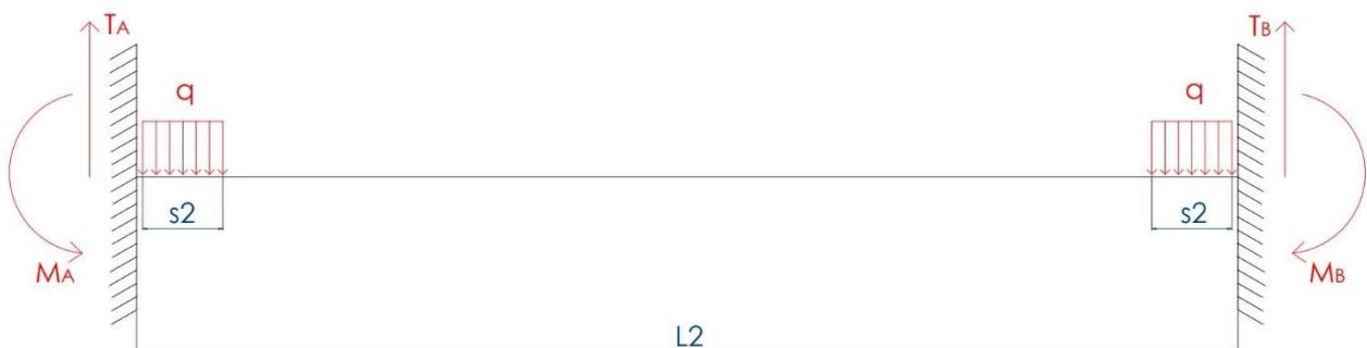
Figure 50: Schematizzazione come trave dell'albero trasversale in C
