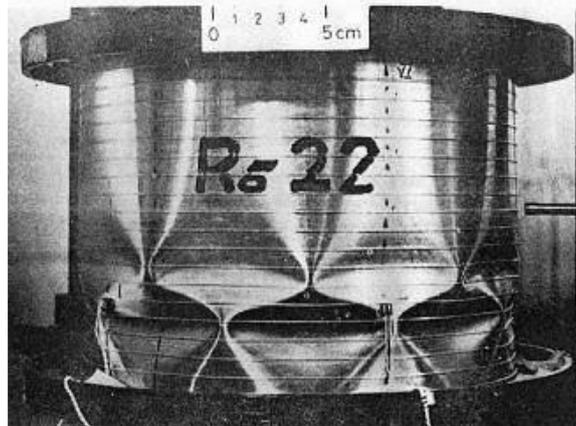
Figura 21: Esempio di deformazione a buckling di un cilindro
