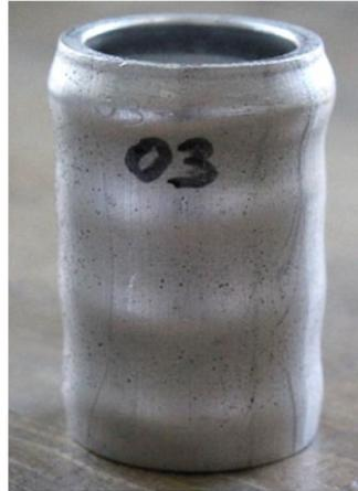
Figura 33: Esempio di deformazione post-buckling di un campione cilindrico a parete spessa [4]
