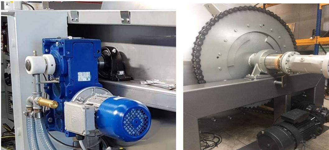
**Figure 2.5** Trasmissione potenza tramite riduttore pendolare (sinistra), Trasmissione di potenza tramite catena (destra)
