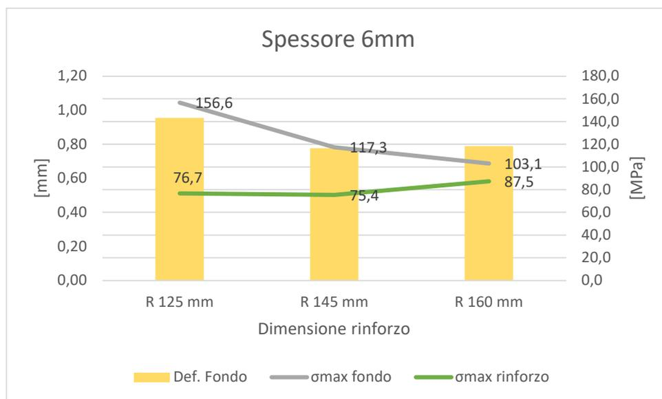
**Figure 6.36** Grafico andamento deformazioni-tensioni rinforzo 6 mm.
