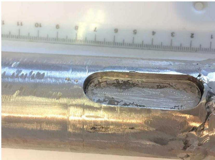
**Figure 3.3** Dettaglio cava linguetta asse aria Pressa F/C 22.
