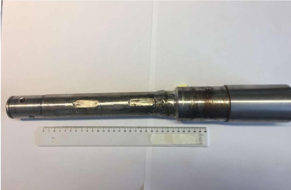
**Figure 3.2** Asse aria Pressa F/C 22, caso di cedimento con successiva riparazione momentanea del cliente.
