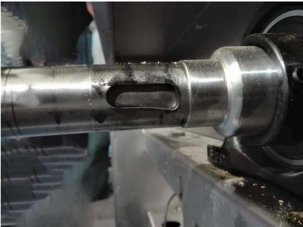
**Figure 3.5** Dettaglio deformazione su asse aria Pressa F/C 22.
