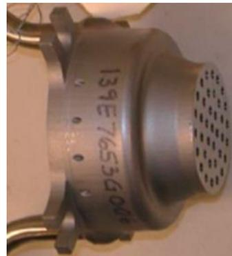
Figura 33: Fotografia di un miscelatore multitubo per combustibili ad alto contenuto di idrogeno [10]
