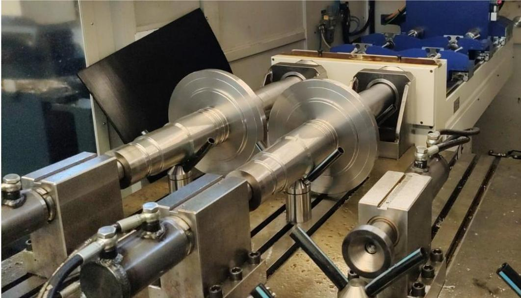
*Figura 28 - Foratura tramite punta cannone*
