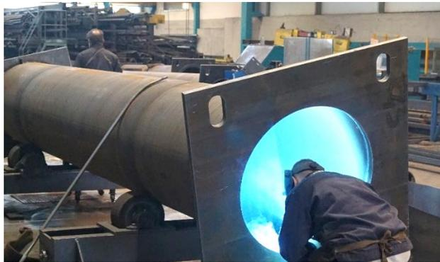
**Figura 1-12 esecuzione della saldatura**
