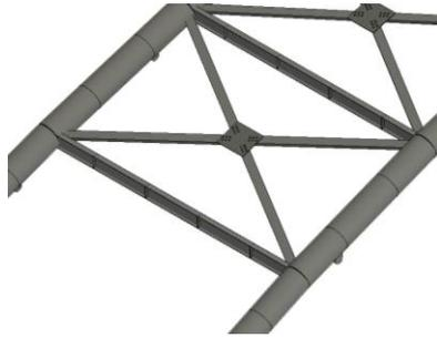
Figura 4-35 REVIT Particolare traversi superiori del ponte.
