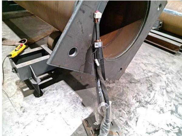
**Figura 1-26** apporto di calore per convezione per il rinvenimento delle zone termicamente alterate
