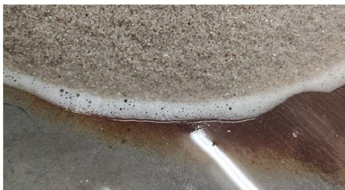
**Figura 5.4:** Particolare della prova di slump del Terreno A
