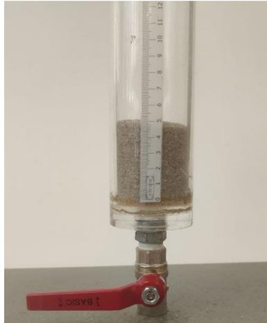
**Figura 4.10:** Riempimento della cella per strati
