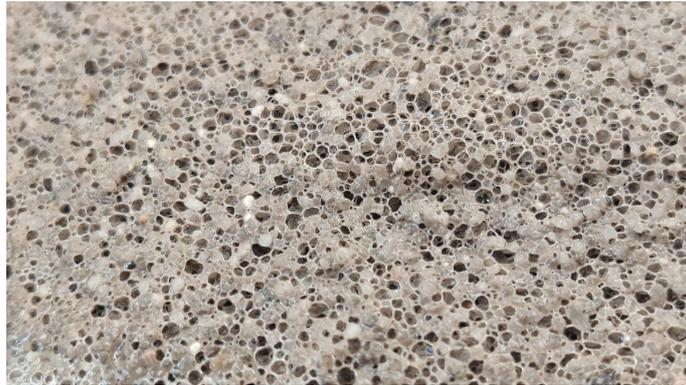
**Figura 4.3:** Foto di un terreno condizionato in laboratorio
