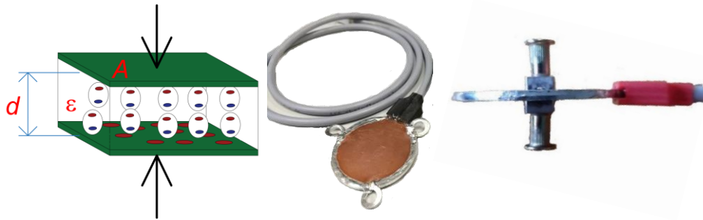
Figura 1.6 Schema dielettrico e sensore capacitivo
