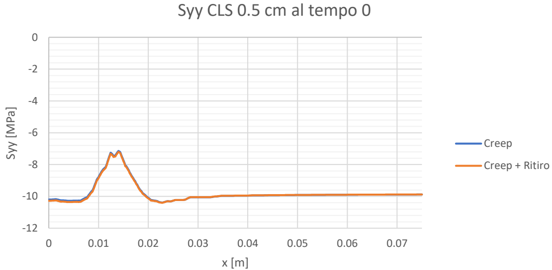
Figura 2.86 Syy CLS a 0.5 cm al tempo: 0, immediatamente successivo all'applicazione del carico
