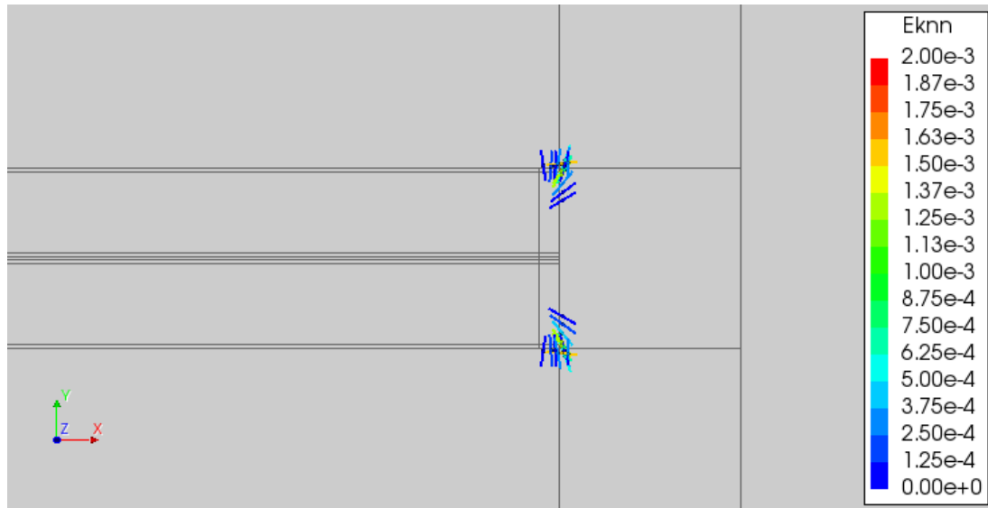
Figura 4.16 Stato fessurativo a distanza di 1 anno dall'applicazione del carico
