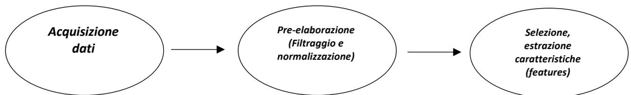
**Figura 3.16** Schema processo del monitoraggio basato sulle vibrazioni (classico Statistical Pattern Recognition (SPR) paradigm) [105]
