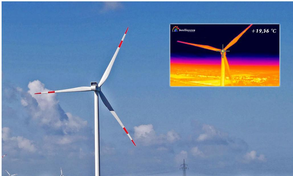
**Figura 3.12** Termografia applicata a livello di sistema (Intellisystem.it)
