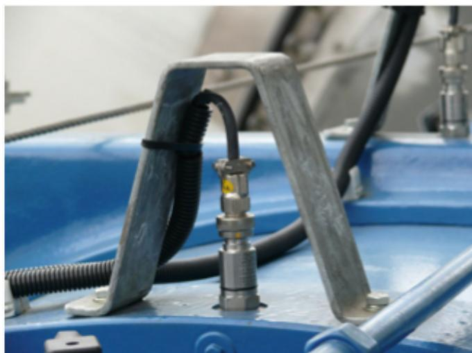
**Figura 3.17** Esempio di accelerometro posizionato su un riduttore (Fonte [107]).
