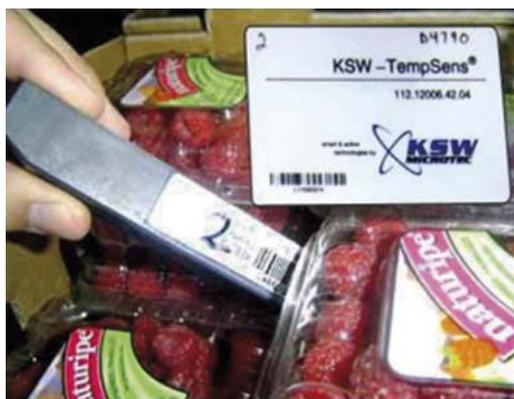
Figura 7- Tag Semi attivo con sensore di temperatura
