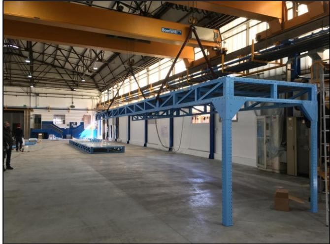
Figura 4.1: Carroponete impiegato per il sollevamento di carpenteria metallica
