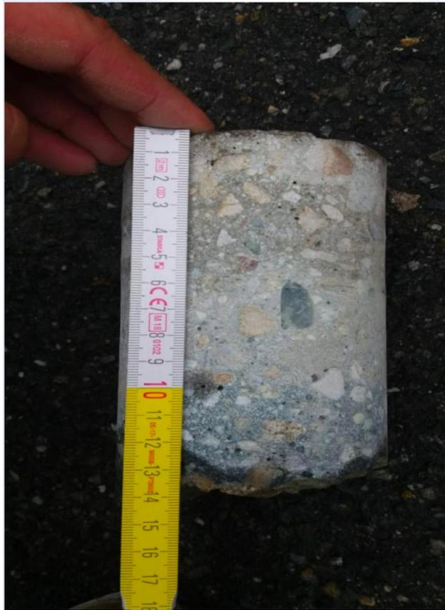
Figura 5.14: Campione pavimento per prova carotaggio
