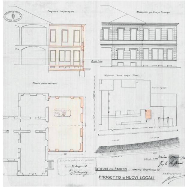
Progetto di rialzamento di parte di edificio
