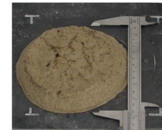
FIGURA\_3 Misurazione del diametro dei campioni mediante calibro, al termine della prova.
