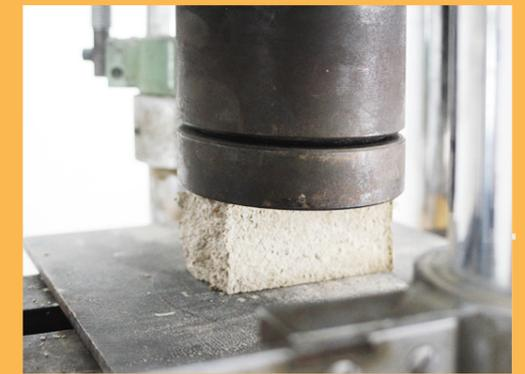
FIGURA\_19 Moncone D.R.I.N.C. B\_25 prima della prova
