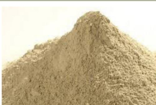
FIGURA\_4 Calce idraulica
