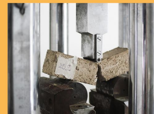
FIGURA\_13 Provino D.R.I.N.C. B\_25 al termine della prova
