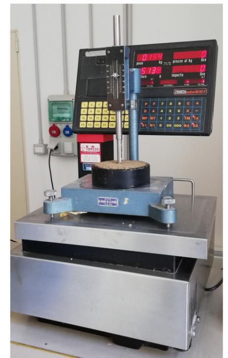
FIGURA\_8 Lettura della massa al termine della prova per determinare il tempo di lavorabilità
