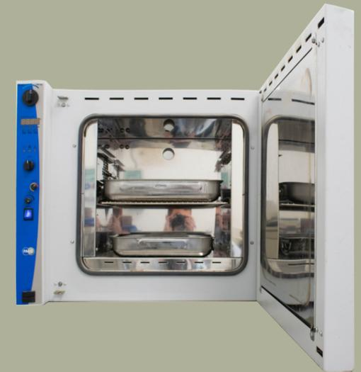
FIGURA\_11 Forno ventilato utilizzato per essiccare
