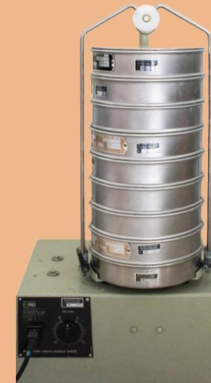
FIGURA\_10 Vibrovaglio circolare Controls
