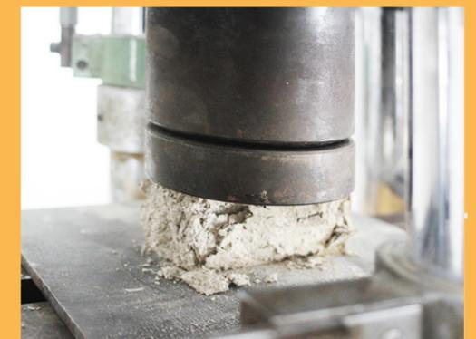
FIGURA\_20 Moncone D.R.I.N.C. B\_25 al termine della prova
