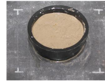
FIGURA\_1 Immissione della malta nello stampo troncoconico
