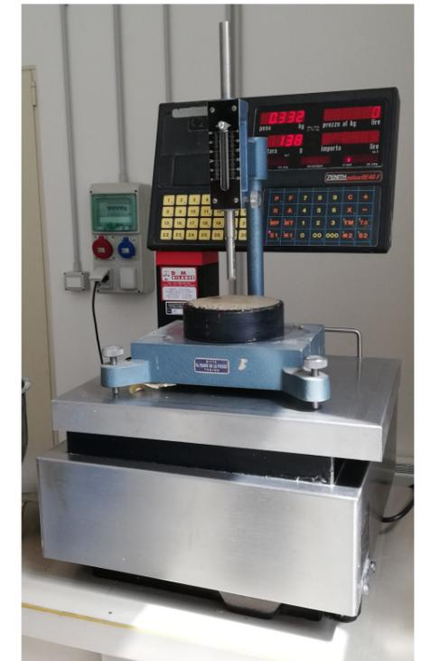
FIGURA\_7 Attrezzatura prima dell'inizio della prova per la determinazione del tempo di lavorabilità
