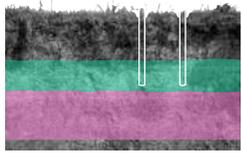
Fig. 1 - Con esempio con contaminazione legata alla presenza di una fase organica libera sommatante la falda (LNAPL)
