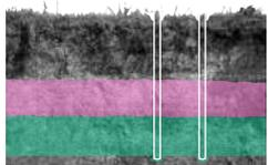
Fig. 3 - esempio con una contaminazione legata alla presenza di una fase organica depositata sul fondo dell'acquifero (DNAPL)
