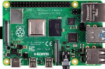
**Figure 3.2:** Raspberry Pi4-Model B
