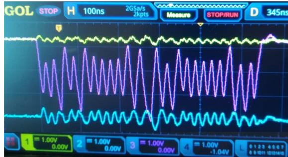
Figura 3.4: In **viola** è mostrato il segnale trasmesso, in **blu** il `srdy` e in **giallo** il `drdy`.
