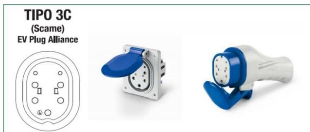
Mono/trifase, 2 contatti pilota, max 32A (63A), 230/400V, si trova solo sulle colonnine, ormai in disuso.
