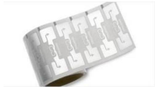
*Figura 18. esempio reale di tag passivo*
