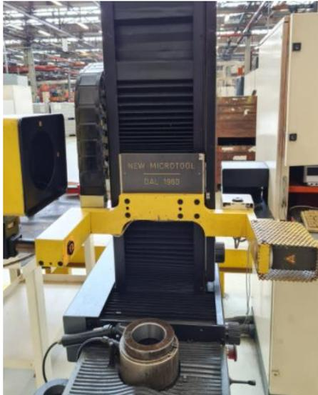
Figura 12: macchina pre-setting con visore ottico
