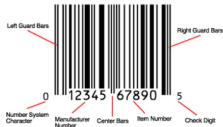
Figura 21: caratteristiche principali di un BAR CODE UPC
