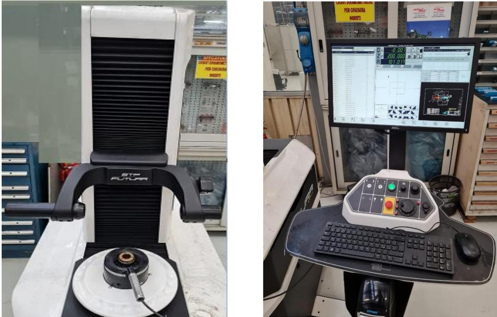
*Figura 11:macchina pre-setting utensile e visualizzatore dati (sulla sx)*
