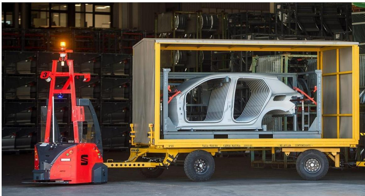
*Figure 15: Veicolo a guida autonoma (in rosso) a lavoro nello stabilimento di Martorell*
