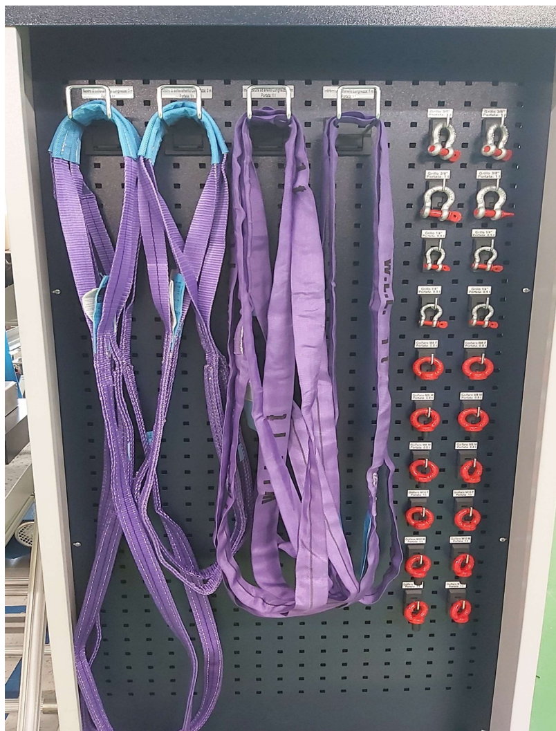
Fig. 4.17 Sistemazione degli accessori di sollevamento (cinghie, golfari e grilli) utilizzando le 5S
