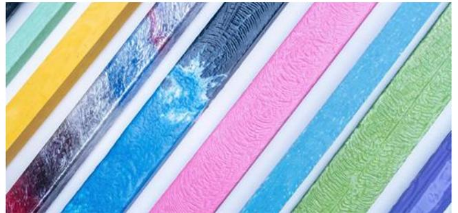
Figura 1.20. Travi realizzate con plastica riciclata, Precious Plastic
