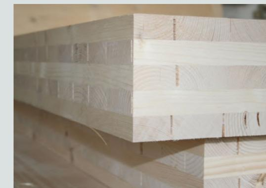
**Figura 1.23.** Pannello in X-Lam. Fonte: <https://www.teknoing.com/news/ingegneria-strutturale/legno-strutturale-dimensioni-e-spessore-dei-pannelli-xmlam/>
