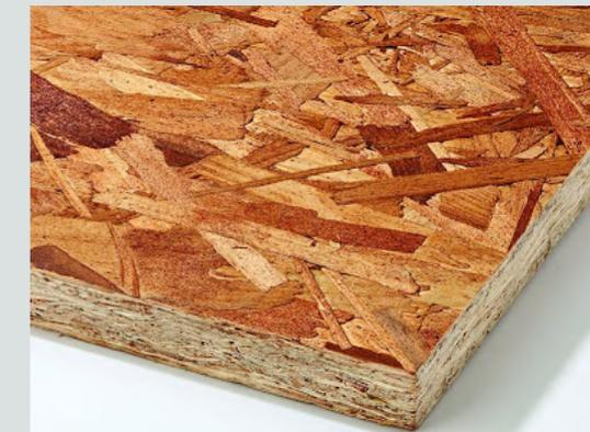
**Figura 1.25.** Pannello in OSB. Fonte: [amorelegnami.it/forniture/pannelli-in-legno/pannelli-osb.html](http://amorelegnami.it/forniture/pannelli-in-legno/pannelli-osb.html)
