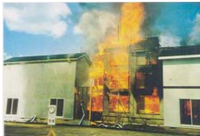
**Figura 3.31** Esperimento sul condominio in legno a tre piani dopo circa tre ore dall'accensione dell'incendio, condotto da Hasemi Laboratory. Fonte: *Hasemi Laboratory*
