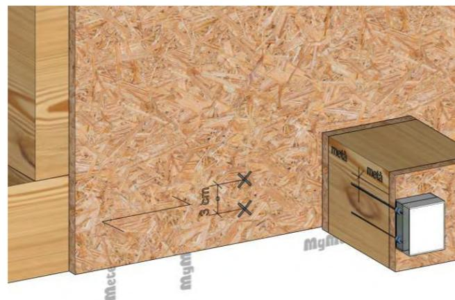
**Figura 5.27** Sistema a telaio: posizionare gli elettrodi trasversalmente rispetto alla fibra del legno e fissarli a metà circa della banchina del telaio. Fonte: <https://woodcontrol.eu/>
