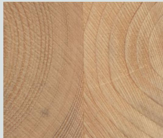
**Figura 1.16.** Trave Bilama. Fonte: <https://www.teknoring.com/news/ingegneria-strutturale/legno-strutturale-le-travi-bilama-e-trilama/> (Foto Davide Maria Giachino)
