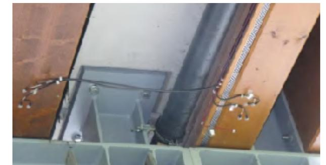
**Figura 5.22** Sensori per la misurazione dell'umidità e la temperatura del legno sotto il ponte a Hönigesberg, Germania. Fonte: Koch J., Simon A., Arndt R.W., 2016, *Monitoring of moisture content of produced timber bridges*, seminario WCTE 2016 World Conference on Timber Engineering Agosto 22-25
