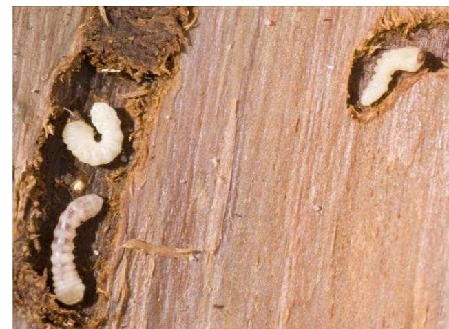
**Figura 3.5** Degrado causato da larve di termiti: si possono notare i fori causati dalle larve. Fonte: [www.casette-italia.it](http://www.casette-italia.it)
