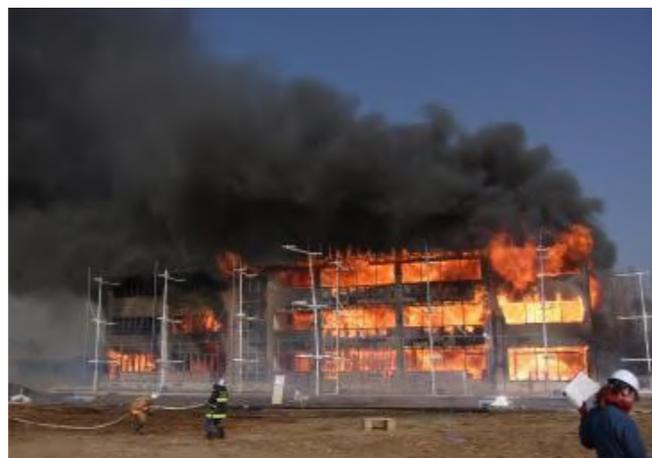
**Figura 3.32** Esperimento preliminare antincendio su un edificio scolastico a tre piani in legno condotto da Hasemi Laboratory nel 2012. Fonte: *Hasemi Laboratory*
