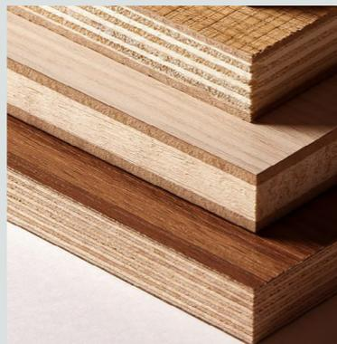
**Figura 1.24.** Pannello in compensato. Fonte: <http://www.ala-siafranco.com/pannello-di-compensato/?lang=it>
