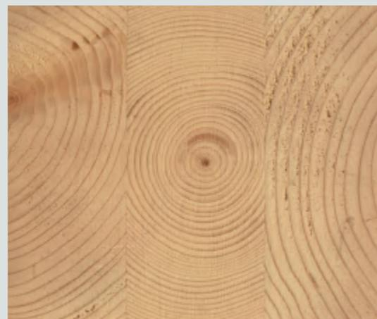
**Figura 1.17.** Trave Trilama. Fonte: <https://www.teknoring.com/news/ingegneria-strutturale/legno-strutturale-le-travi-bilama-e-trilama/> (Foto Davide Maria Giachino)
