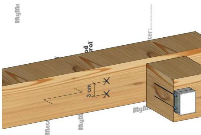
**Figura 5.28** Corretto posizionamento dei sensori nelle travi in legno: posizionare gli elettrodi trasversalmente rispetto alla fibra del legno. Fonte: <https://woodcontrol.eu/>
