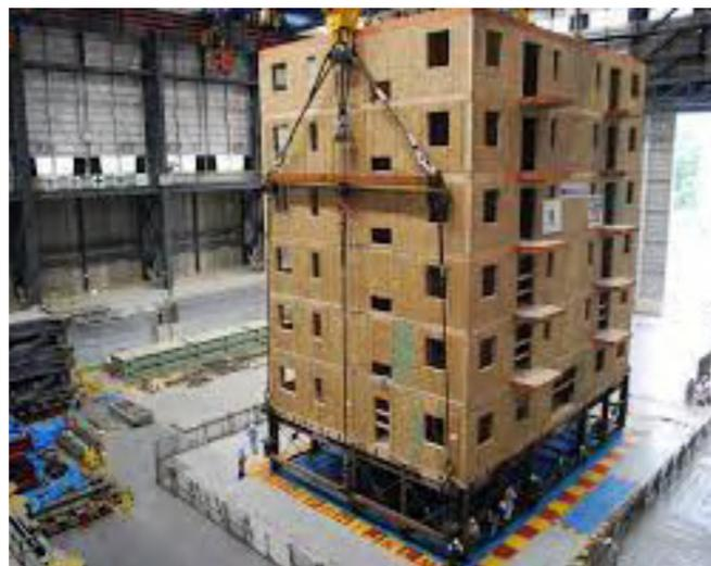
**Figura 3.26** Edificio "NEESWood" testato sulla piattaforma vibrante a Kobe in Giappone. [Fonte: https://www.lacasaecologia.co/tecnologia-produttiva](https://www.lacasaecologia.co/tecnologia-produttiva)
