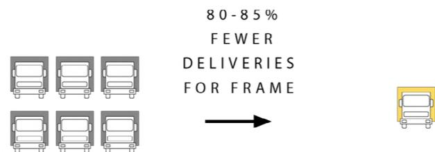
**Figura 1.32.** Riduzione dei trasporti per la consegna dei materiali da costruzione in un cantiere prefabbricato, rispetto a un cantiere tradizionale. Fonte: Waugh Thistleton Architects, 2018, 100 *Project UK CLT*, scaricato da [www.thinkwood.com](http://www.thinkwood.com) pag.48
