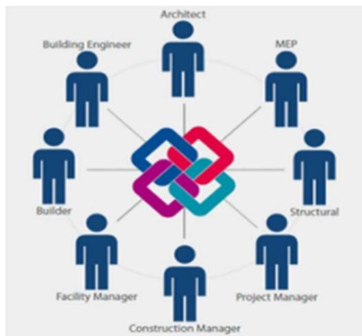
Figura 3 Condivisione di informazioni mediante ifc
