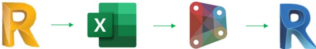
Figura 57 Workflow per l'esportazione delle sollecitazioni da Robot a Revit
