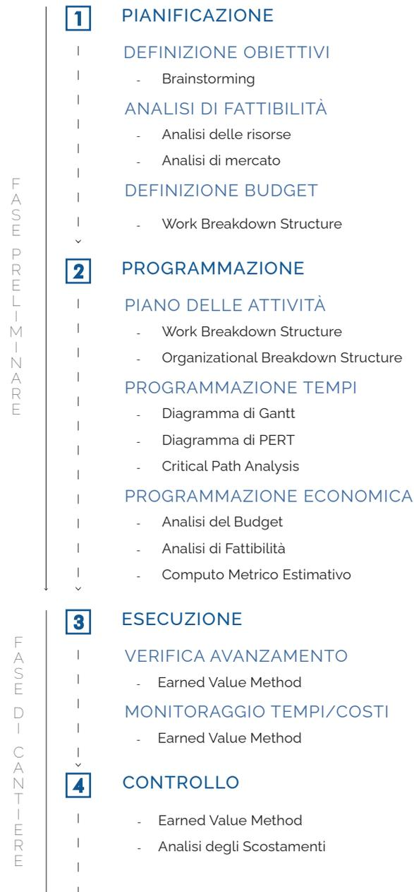
Figura 1.14. Fasi operative di Project Construction Management e strumenti operativi caratterizzanti.
