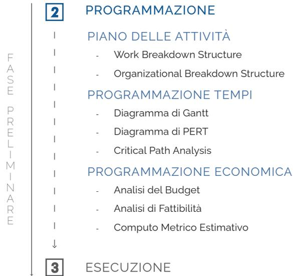
Figura 1.5. Fase di Programmazione, indicazione delle sotto-fasi e strumenti operativi caratterizzanti.
