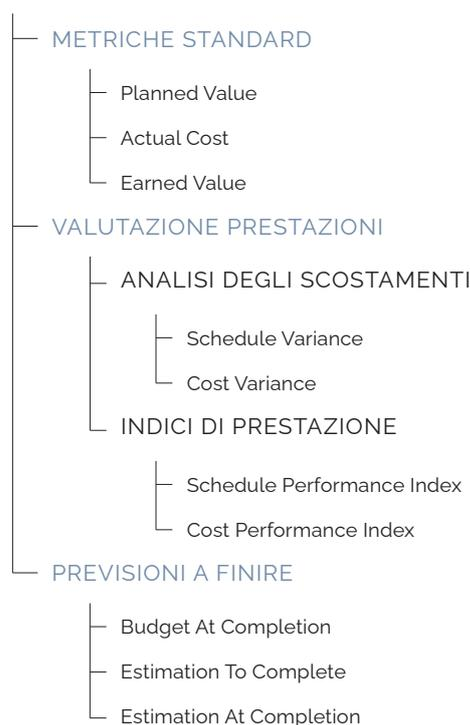
Figura 4.11. Metriche standard, indicatori di prestazione e stime a finire dell'Earned Value Method.
