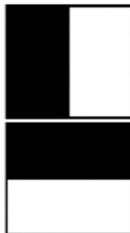
Figura 2.8 rappresentazione della wavelet Haar lungo x (in alto) e lungo y (in basso)
