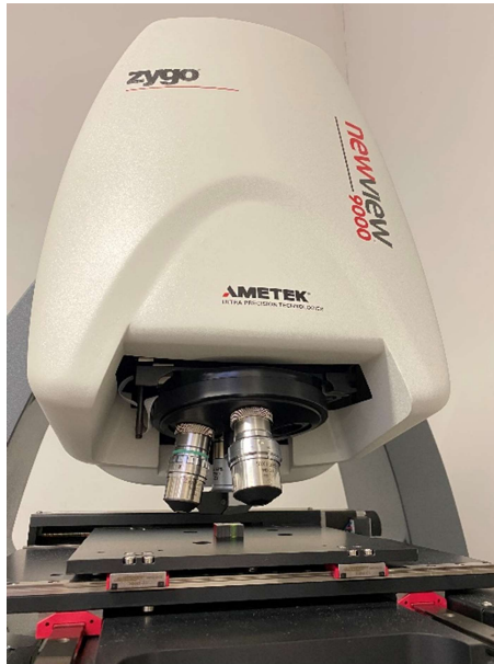
Figura 3.6 CSI Zygo NewView 9000. Lo strumento, utilizzato nel lavoro di ricerca, si trova nel Laboratorio di metrologia superficiale presso il Politecnico di Torino, Italia.
