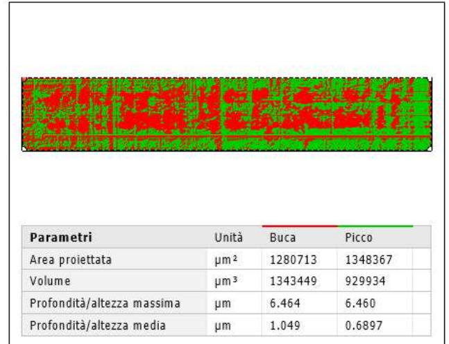
Figura 6.45 Caratterizzazione del volume d'usura mediante il metodo automatico di MountainsMap. A sinistra i risultati si riferiscono allo studiabile registrato con ICP, a destra con Surf+Icp
