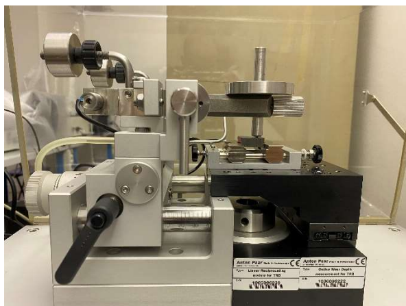
Figura 5.24 Illustrazione del tribo-test Anton Paar TRB (Laboratorio di Meccanica, Politecnico di Torino, Italia) utilizzato (a sinistra); configurazione Pin-on-Plate lineare del test di modello (a destra)
