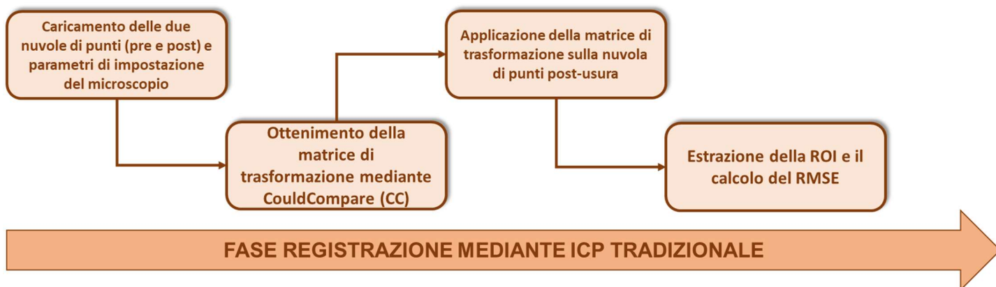
Figura 5.1 Workflow del codice nel main per la registrazione delle nuvole di punti
