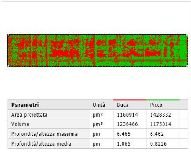
Figura 6.45 Caratterizzazione del volume d'usura mediante il metodo automatico di MountainsMap. A sinistra i risultati si riferiscono allo studiabile registrato con ICP, a destra con Surf+Icp
