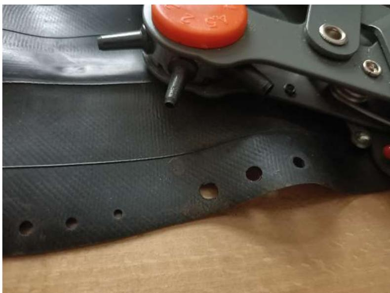
Si può forare con l'ausilio di una pinza fustellatrice, ma le prestazioni variano in base al diametro impiegato per praticare il foro: la fustellatrice presenta 6 diametri diversi: 2.0, 2.5, 3.0, 3.5, 4.0, 4.5 indicate in millimetri, e all'aumentare del diametro i fori si fanno più difficili da praticare e più irregolari nel disegno del diametro.
