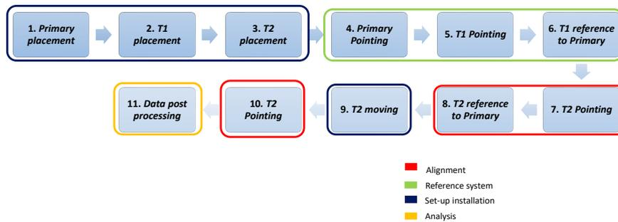
Figure 6.10: Alignment flow for mini CMG 3.
