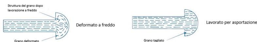
Figura 2.4: Effetti sulla microstruttura dei processi di lavorazione
