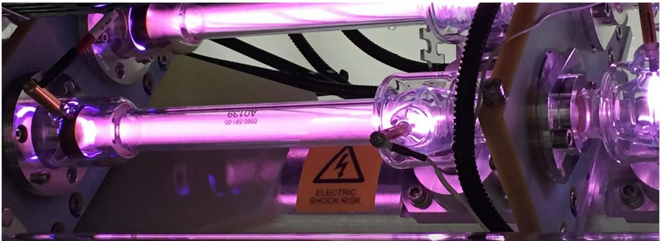
*Figura 1.9: Sorgente laser con tecnologia CO<sub>2</sub>*
