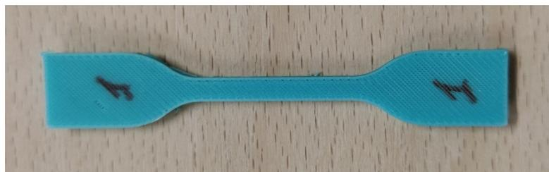
Figura 4.55: Provino ad osso di cane costituito da 30 Talco 50 Mask.
