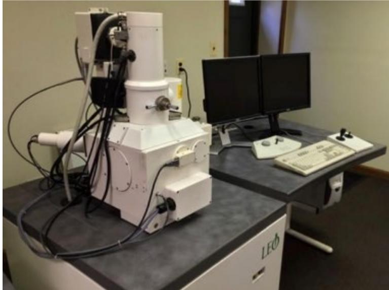
*Figura 3.22: Microscopio SEM LEO-1450VP.*
