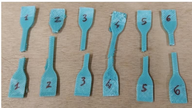
Figura 4.72: Provini costituiti da 30 Talco 35 Mask dopo le prove di trazione.
