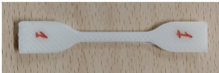
Figura 4.53: Provino ad osso di cane costituito da P-Lene T 15.
