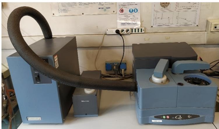
*Figura 3.13: Strumento usato per lo svolgimento di prove di calorimetria differenziale, DSC Q20.*
