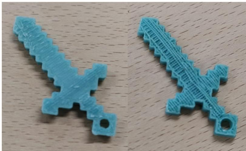
Figura 4.57: Portachiavi a forma di spada costituito da 30 Talco 35 Mask. A sinistra il fronte, a destra il retro.
