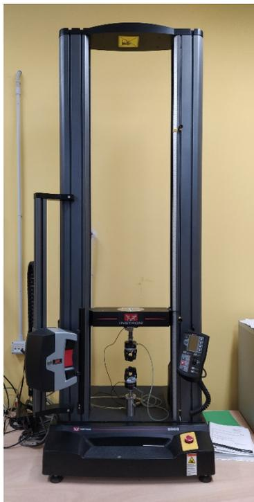
Figura 3.21: Dinamometro Instron 5966.
