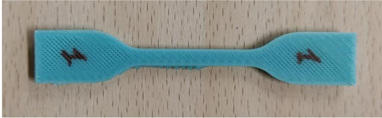
Figura 4.51: Provino ad osso di cane costituito da 30 Talco 35 Mask, realizzato con i parametri della quarta prova.
