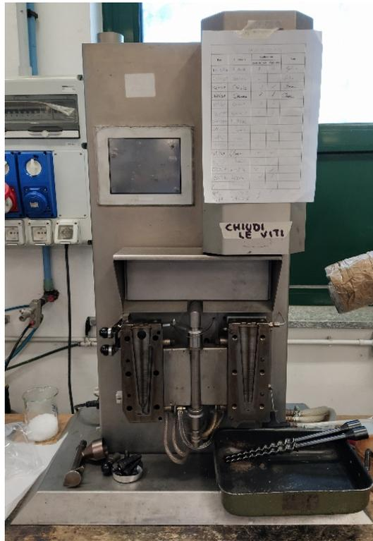
Figura 3.9: Miniestrusore bivite Xplore MC 15 con camera aperta.
