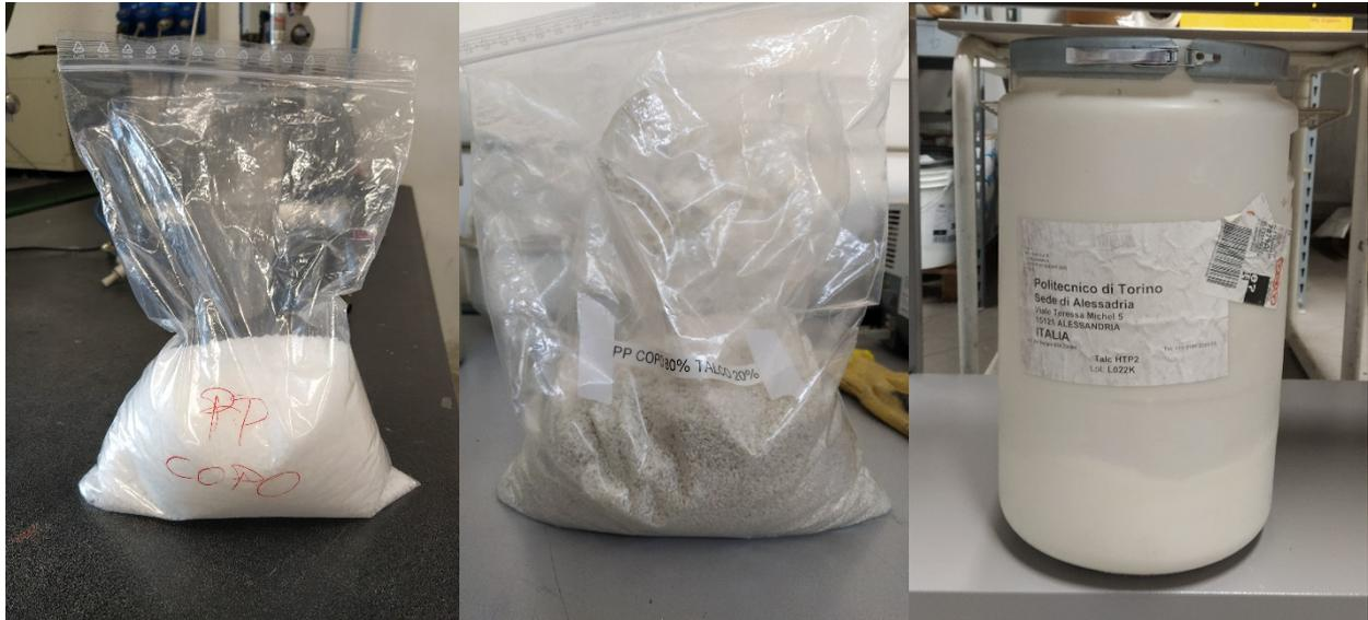
Figura 3.3: Materiali utilizzati per il compounding con mascherine. A sinistra il PP Copo, al centro il PP Talco, a destra il talco IMI FABI HTP 2.
