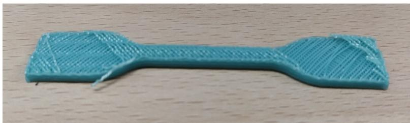
Figura 4.50: Retro del provino stampato con i parametri della seconda prova, si notino i tratti mancanti strappati dal raft.
