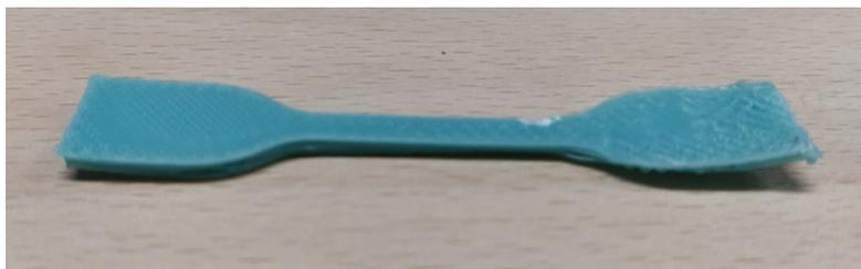
Figura 4.49: Provino incompleto realizzato con i parametri della prima prova, si noti l'imbarco.
