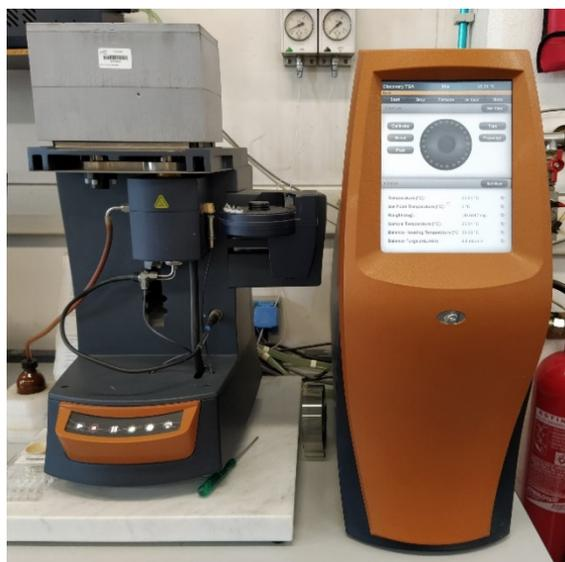
*Figura 3.12: Strumento usato per lo svolgimento delle TGA, Discovery.*
