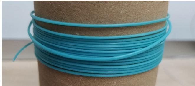
Figura 4.45: Filo di 30 Talco 50 Mask realizzato con i parametri della terza prova.
