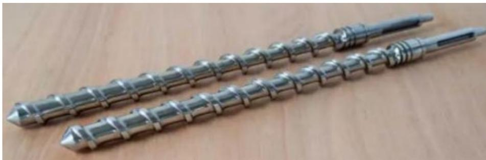
*Figura 3.17: Vite dell'estrusore Next 1.0 Advanced.*
