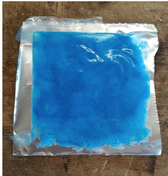
*Figura 3.6: Un quadrotto costituito da mascherine compresse tramite la pressa a piatti piani.*
