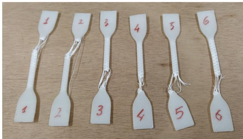
Figura 4.70: Provini costituiti da P-Lene T 15 dopo le prove di trazione, si notino i perimetri ancora integri.
