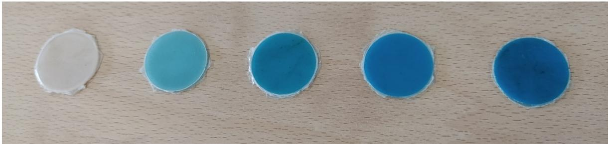
Figura 4.1: Dischetti di materiale. Da sinistra: PP Copo, 25 Mask Copo, 50 Mask Copo, 75 Mask Copo, Mask.
