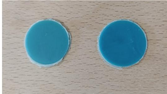
*Figura 4.3: Dischetti di materiale. A sinistra 30 Talco 35 Mask, a destra 30 Talco 50 Mask.*
