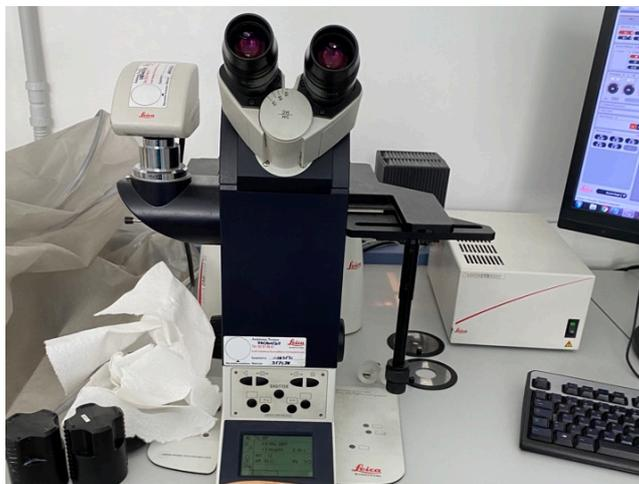
**Figura 3.16** Microscopio ottico *Leica DMI 5000M*
