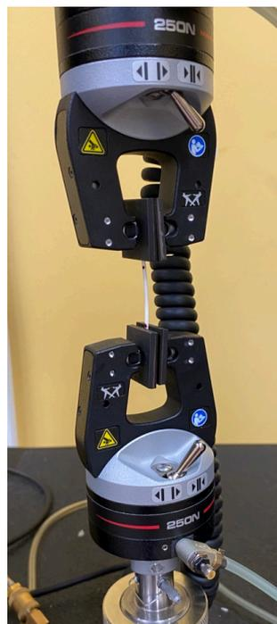
*Figura 3.15 Dinamometro 5966 Instron con filamento in Nylon White*
