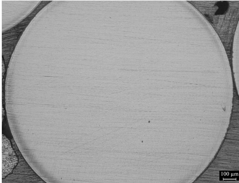
*Figura 4.8 Sezione trasversale del filamento di Nylon White*
