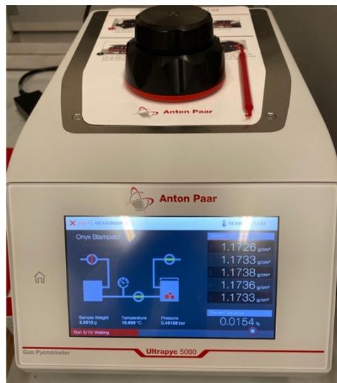
*Figura 3.20 Picnometro a gas Ultracyc 5000 della Anton Paar*
