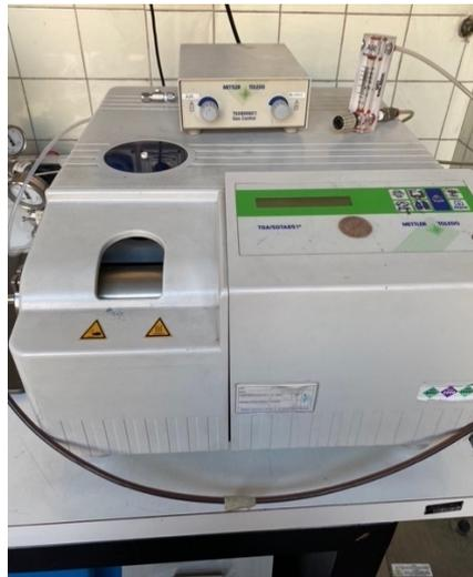
**Figura 3.11** *TGA/SDTA851e* della Mettler Toledo
