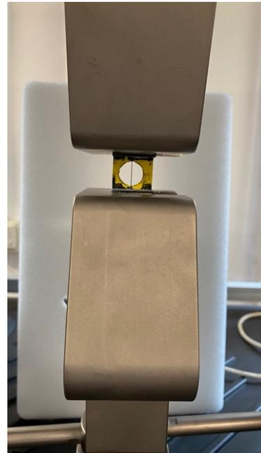
*Figura 3.14 Fibra di carbonio durante prova di trazione*
