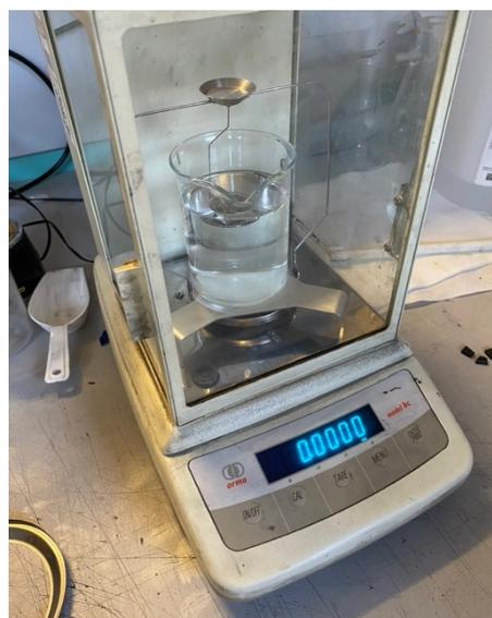
*Figura 3.21 Strumentazione per la prova di Archimede*
