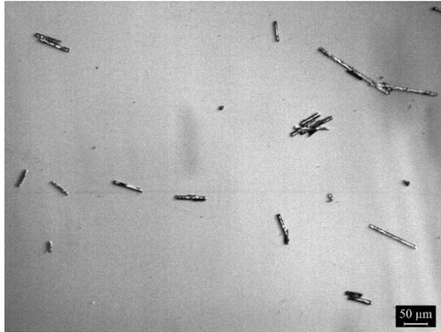
**Figura 4.13** Fibre di carbonio contenute nel filamento di Onyx dopo pirolisi del polimero
