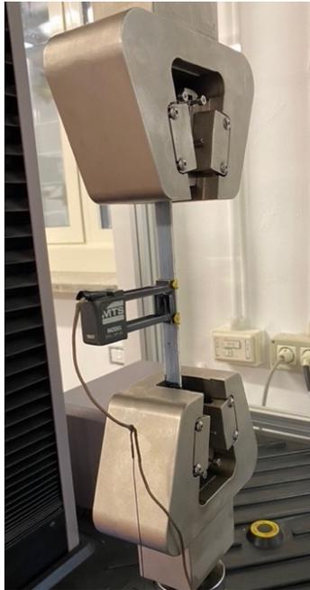
*Figura 3.13 MTS Criterion con provino composito*
