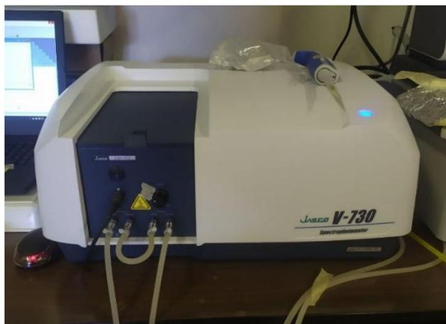
**Figura 6.6** Spettrofotometro UV-Vis-NIR Jasco V-730
