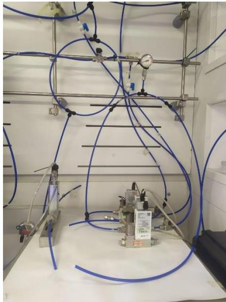
**Figura 6.5** Linea gas per il rifornimento di N<sub>2</sub> e della miscela H<sub>2</sub>/CO<sub>2</sub>. I *mass flow controllers* sono controllati da un software che consente di impostare la portata dei gas
