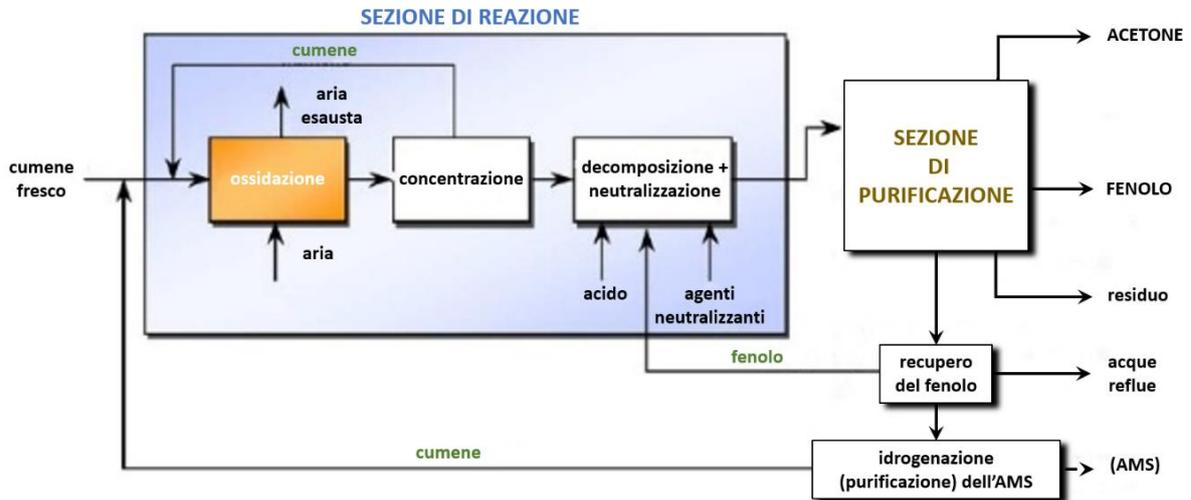
**Figura 4.6** Schema del processo al cumene (figura tratta da Schmidt, 2004 con modifiche)
