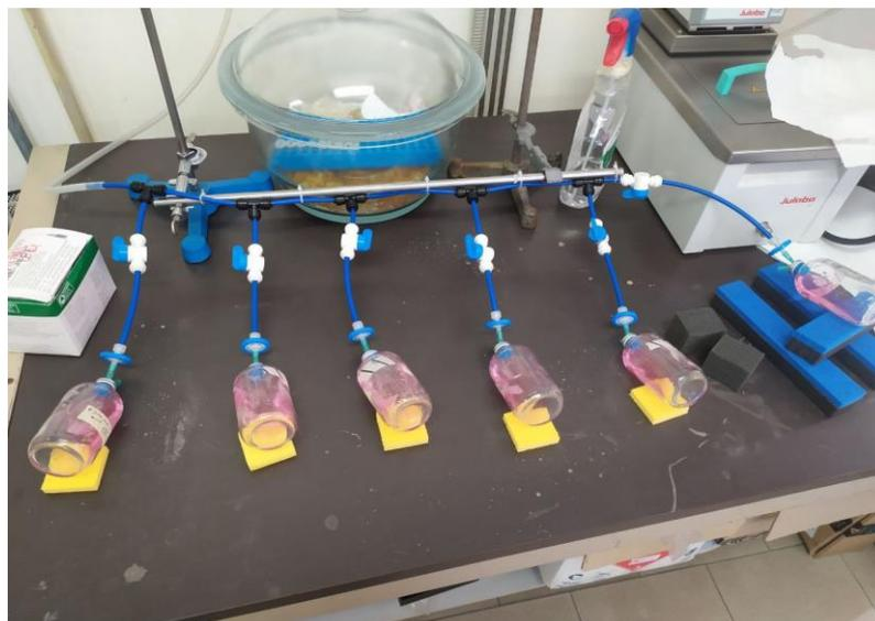
**Figura 6.4** Sistema di degasamento delle *serum bottles*
