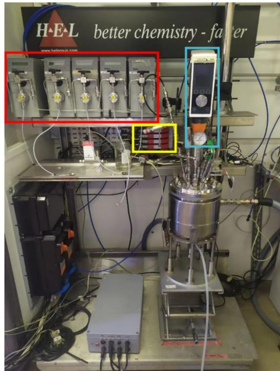
**Figura 6.10** Bioreattore H.E.L. In rosso sono evidenziate le pompe per l'ingresso dei liquidi, in giallo i MFC per la regolazione di gas, in azzurro l'agitatore
