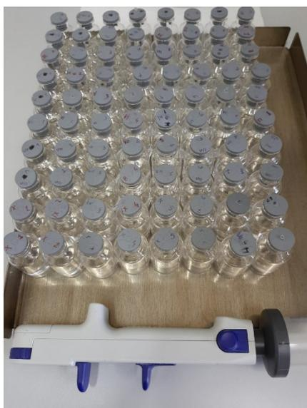
**Figura 2.5** Fase preliminare del processo di liofilizzazione: riempimento dei flaconi
