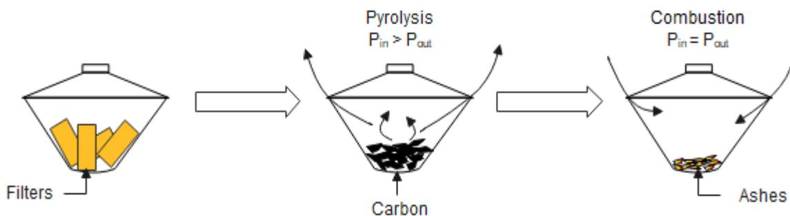
Figura [32], Simulazione del processo che avviene nel forno, elaborazione dell'autore.
