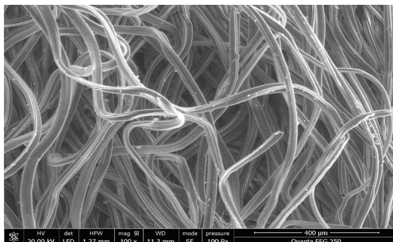
Figura [3], SEM di un filtro di un mozzicone di sigaretta, elaborazione dell'autore.
