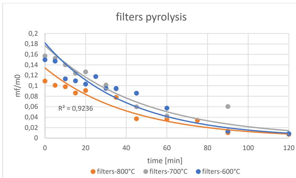
Figura [54], Evoluzione del residuo di massa con l'hold time a 800, 700 e 600°C per i filtri, elaborazione dell'autore.
