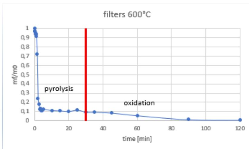
Figura [57], Evoluzione del residuo di massa con l'hold time a 600 °C per i filtri CBs 0-120 minuti, elaborazione dell'autore.
