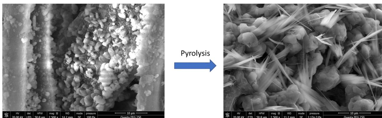
Figura [80], SEM di filtri NaOH prima e dopo la pirolisi, elaborazione dell'autore.
