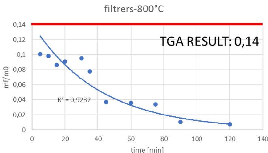
Figura [66], Evoluzione del residuo di massa con hold time a 800°C rispetto al risultato TGA, elaborazione dell'autore.
