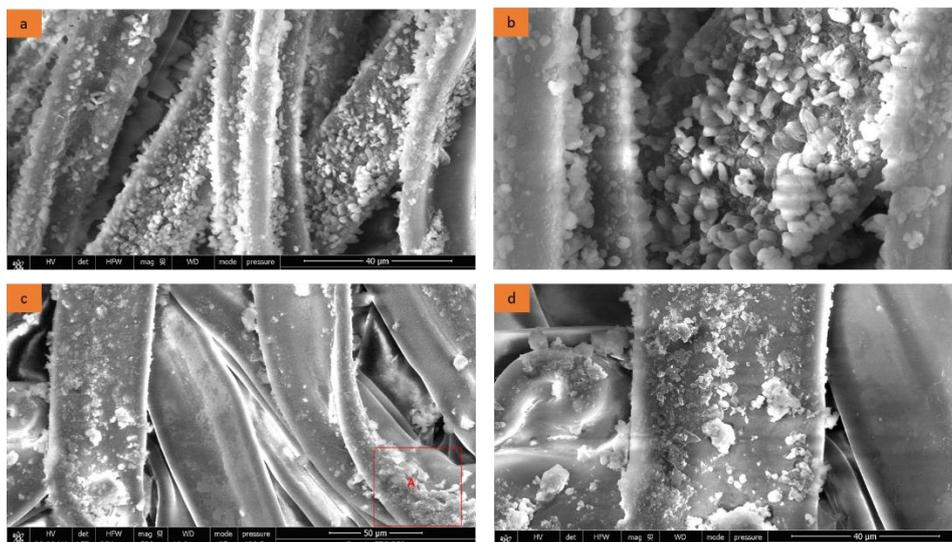
Figura [73], SEM di filtri pretrattati con NaOH (a, b) e filtri laminati (c, d), elaborazione dell'autore.
