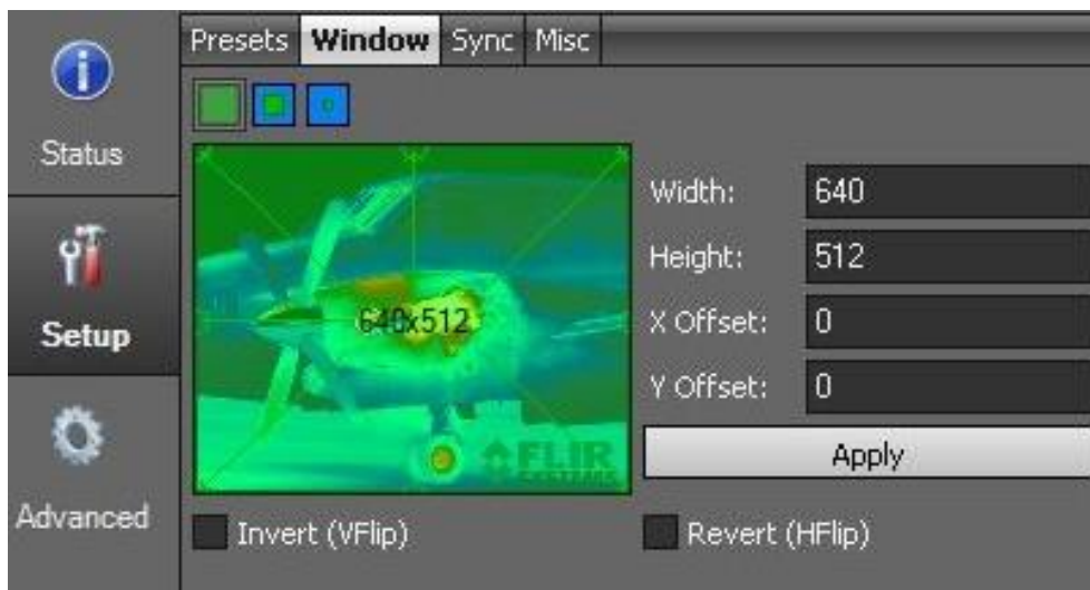
Figura 23. Funzione windowing della termocamera
