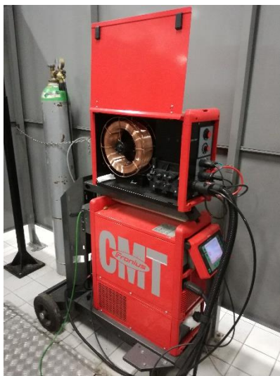
Figura 3. Generatore di saldatura ad arco filo continuo CMT (Fronius)
