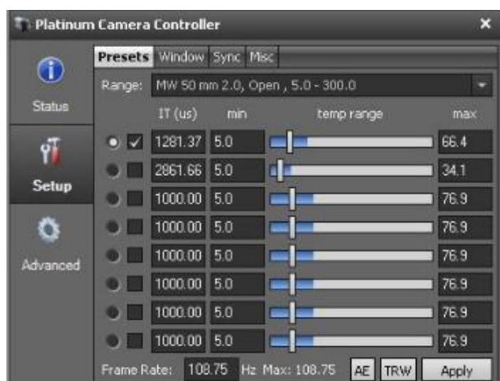
Figura 24. Selezione dei parametri di range di temperatura, IT e frame rate della termocamera
