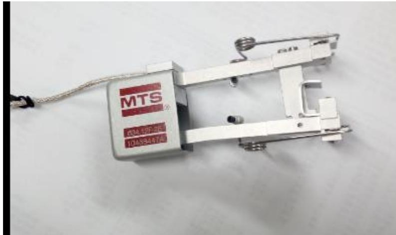
Figura 4.19: Estensimetro MTS utilizzato per il calcolo della deformazione
