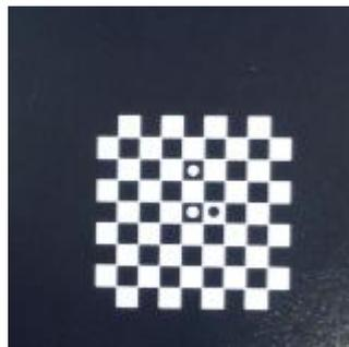
Figura 4.6: Foto calibratore opaco da 4mm utilizzato in laboratorio
