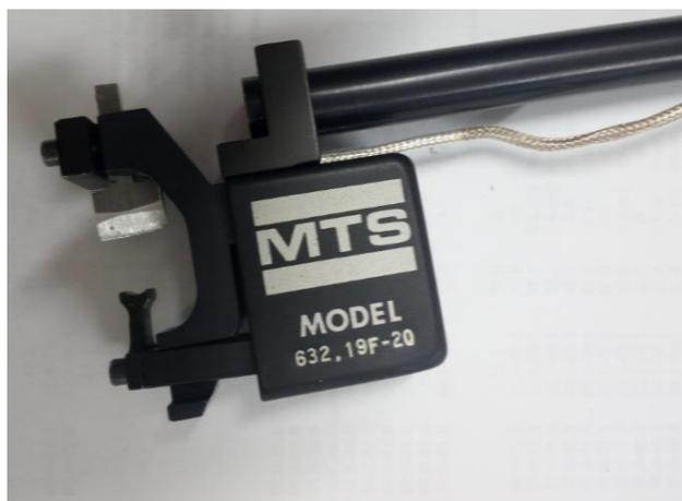
Figura 4.41 : Estensimetro MTS utilizzato per il calcolo della contrazione sul campione
