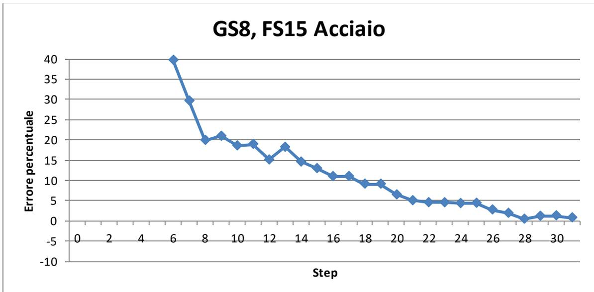
Figura 4.60: Andamento errore percentuale, GS8, FS15, acciaio, calibratore 2mm
