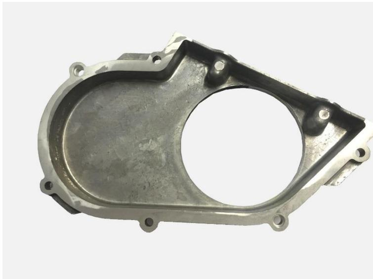
*Figura 20 Vista posteriore del coperchio dell'albero motore*
