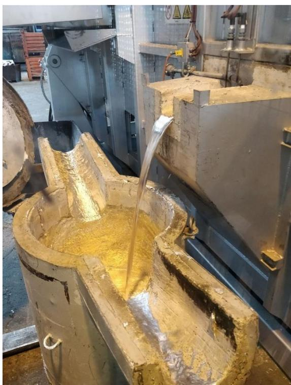
*Figura 8 Siviera mentre viene riempita dal materiale fluido proveniente dal forno fusorio*
