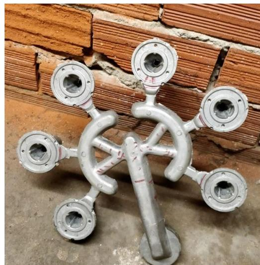
*Figura 42 Particolare del pezzo con tutti i canali di colata*
