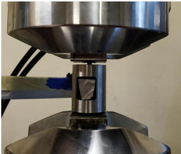
*Figura 33 Supporto posizionato fra gli afferraggi della macchina di trazione*
