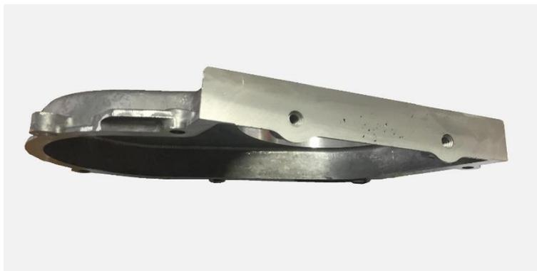
*Figura 21 Vista dall'alto del coperchio dell'albero motore. Sul piano d'appoggio sono ben visibili i due fori filettati oggetto di studio*
