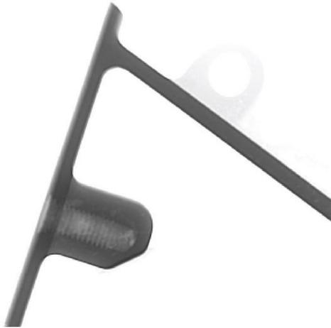
*Figura 23 Foto ai raggi X borchia con porosità 1B*
