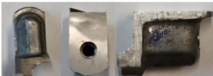
*Figura 17 Borchie utilizzate per le prove di trazione*
