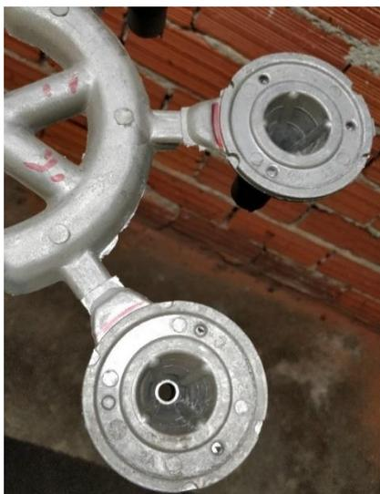
*Figura 41 Particolare del supporto per ammortizzatori (vista interna)*
