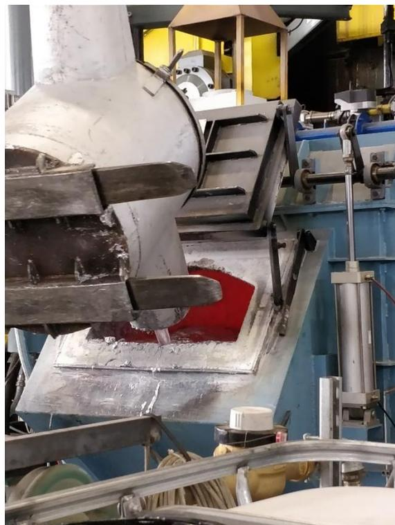
*Figura 9 Siviera mentre sversa il materiale (filtrato in superficie) nel forno di attesa*
