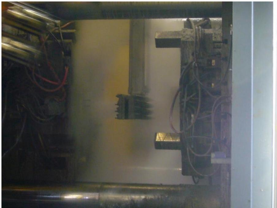
*Figura 16 Ciclo di lubrificazione stampo che avviene prima dell'iniezione della lega fluida*
