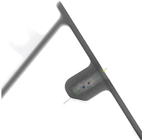
*Figura 21 Foto raggi X borchia con porosità 1A*
