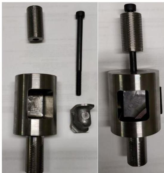
*Figura 35 Supporto prove di trazione. Sulla destra si mostra il montaggio della vite e della borchia poco prima di effettuare la prova di trazione*
