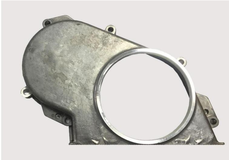
*Figura 19 Vista anteriore del coperchio dell'albero motore*
