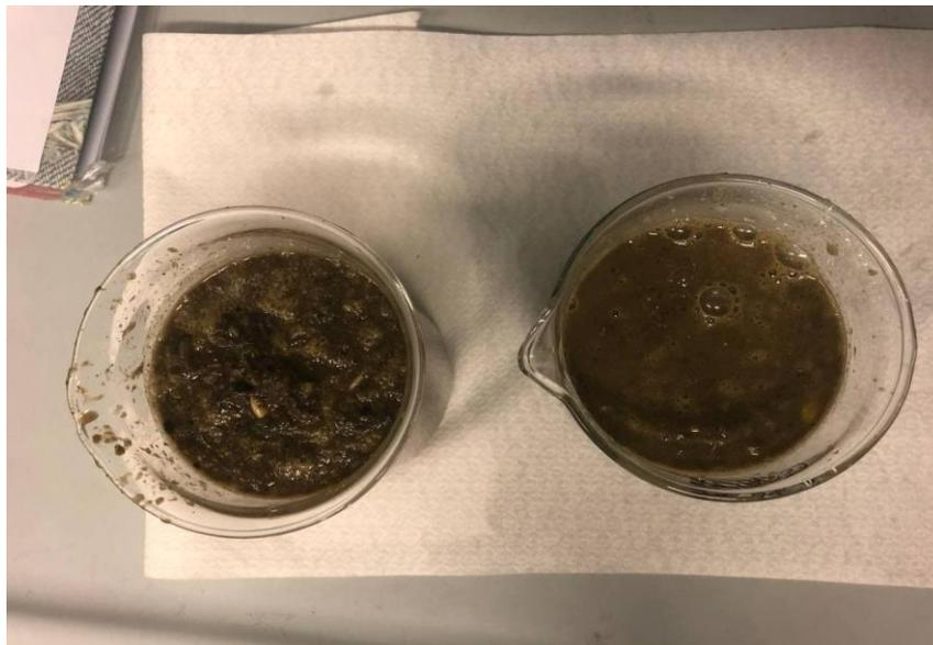
Figura 15 - Confronto visivo dall'alto tra FORSU tal quale (sinistra) e FORSU sottoposta a cavitazione (destra).
