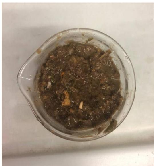
Figura 16 e 17 - FORSU sottoposta ad ultrasuoni utilizzata nelle prove di digestione anaerobica (sinistra) e vista dall'alto (destra).
