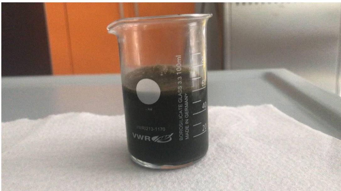
*Figura 13 - FORSU pretrattata meccanicamente utilizzata nelle prove di digestione anaerobica.*
