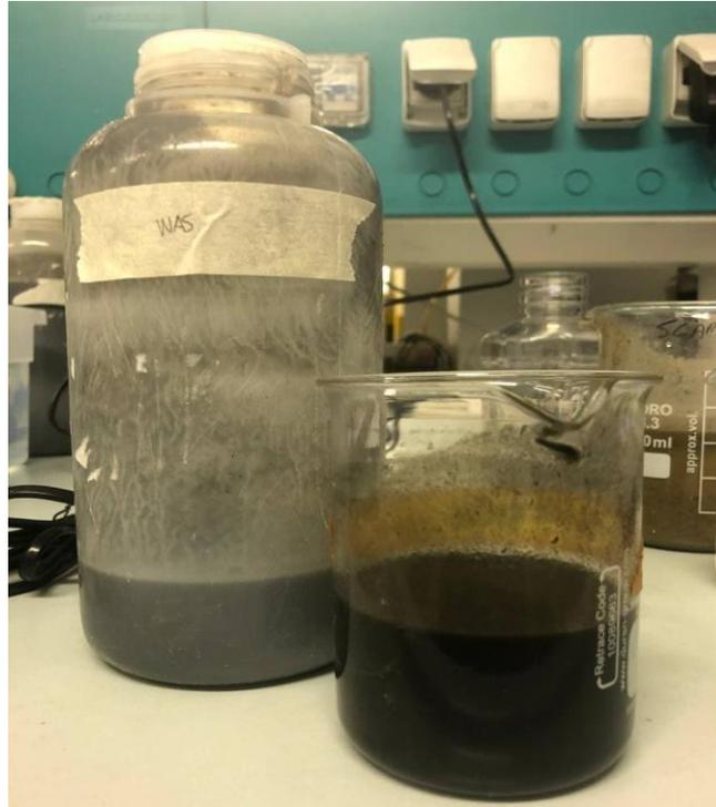
*Figura 6 - Inoculo WAS utilizzato per le prove di digestione anaerobica in laboratorio.*
