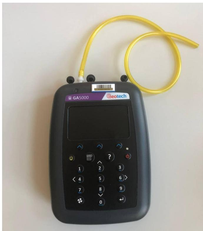
Figura 12 - Gas Analyser GA5000 per valutare la composizione del biogas.
