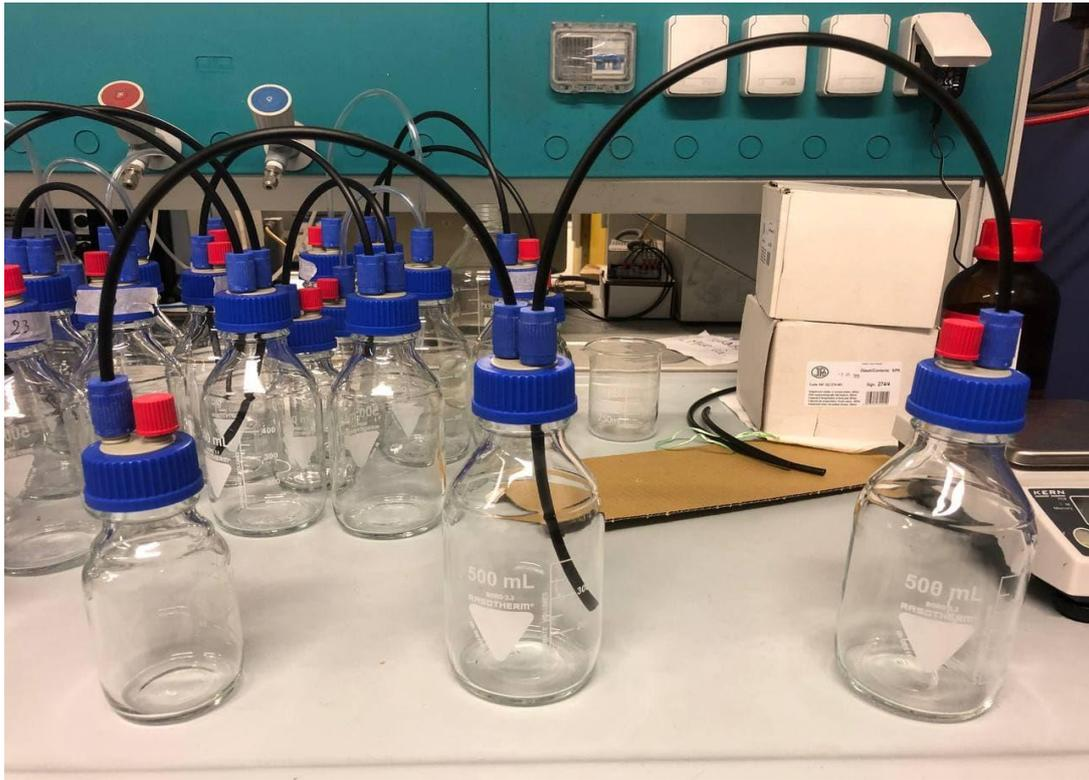
Figura 9 - Sistema con digestore, gasometro e recipiente di raccolta d'acqua utilizzato in laboratorio.
