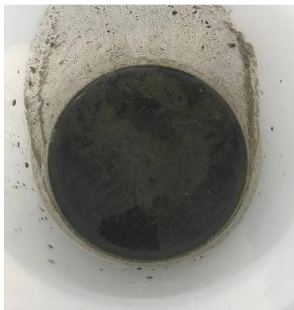
Figura 18 e 19 - FORSU pretrattata termicamente utilizzata nelle prove di digestione anaerobica (sinistra) e vista dall'alto (destra).
