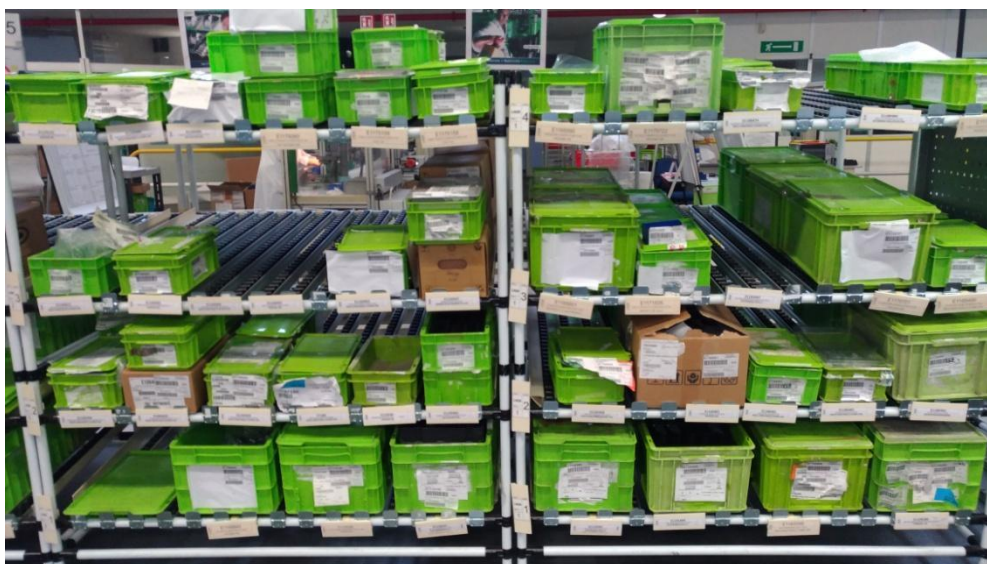
Figura 2-8 : Scaffali di linea dei componenti da assemblare
