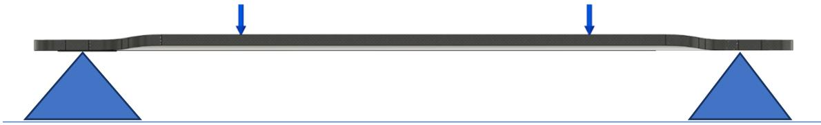
Figura 3.1.3 Schematizzazione Forze applicate nel test, Fusion 360 Autodesk
