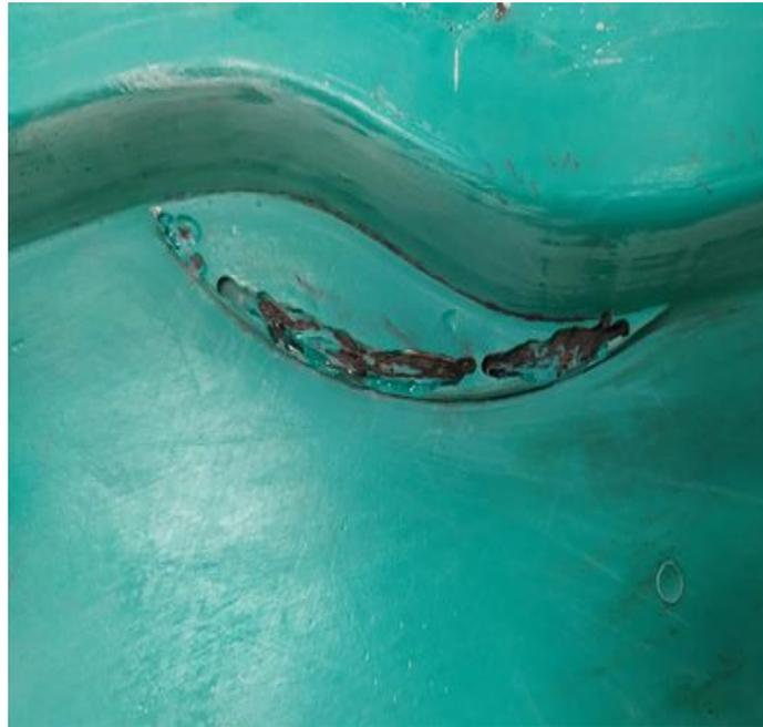
*Figura 4.1.1.7 Vuoti nello stampo rilevati solo dopo il ciclo di post cura*
