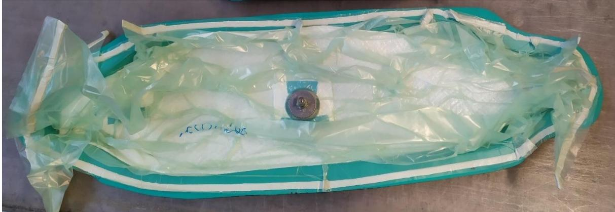
Figura 4.1.1.6 Applicazione sacco per ciclo di post-cura dello stampo
