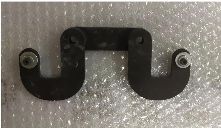
*Figura 4.2.3.2 Maschera di incollaggio prodotta tramite FDM*
