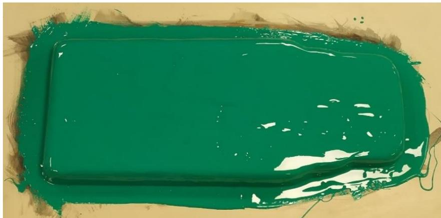
*Figura 4.1.2.5 Applicazione gel coat*
