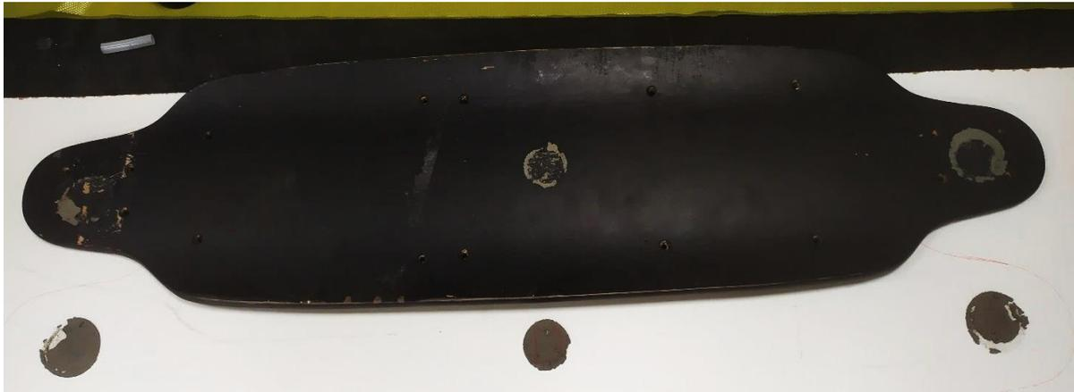
*Figura 4.1.1.2 Risultato prova di deformazione dovute al vuoto*
