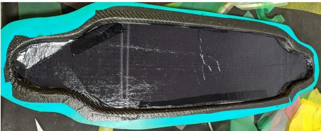
*Figura 4.2.1.4 Rivestimento del core con il film adesivo*
