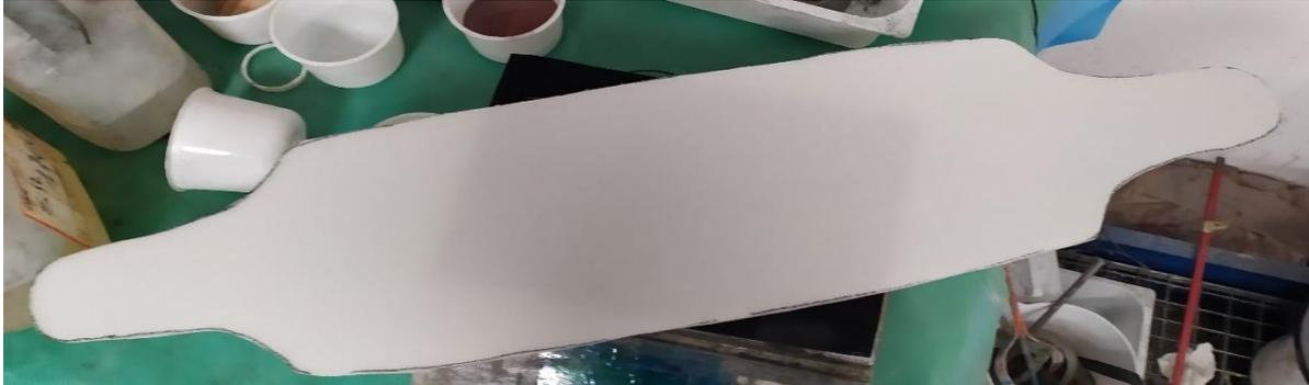
*Figura 4.2.1.6 Core da 8 mm per il SN3*
