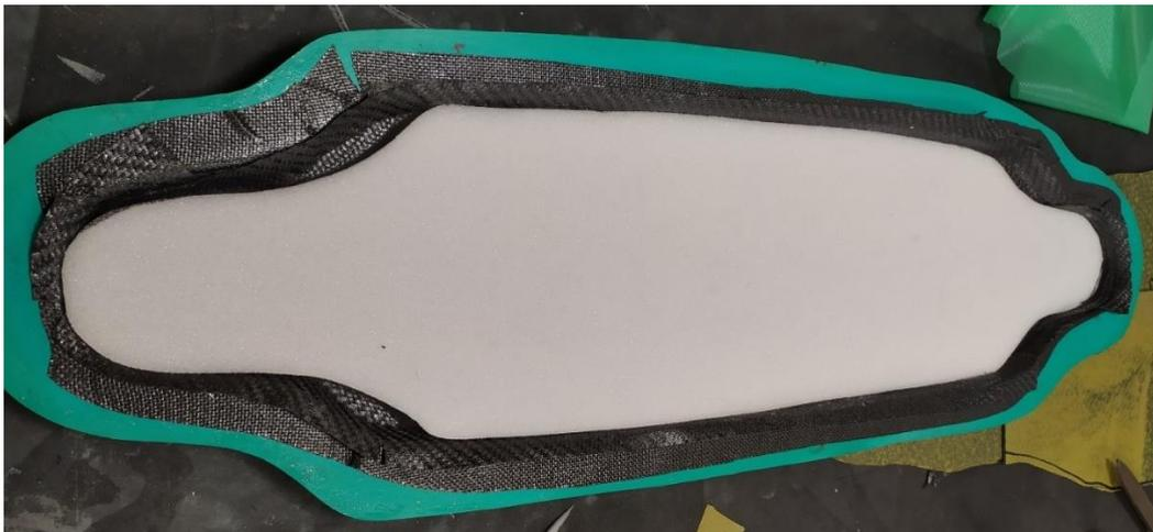
*Figura 4.2.1.3 Adattamento del core allo stampo*
