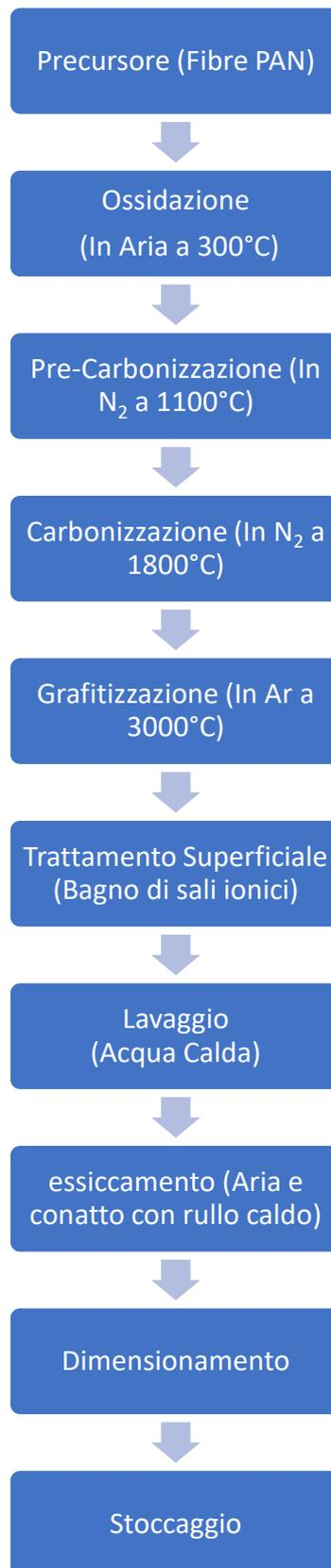
Grafico 2.2.1.3 Diagramma Produzione Fibre di Carbonio da Fibre PAN [24]
