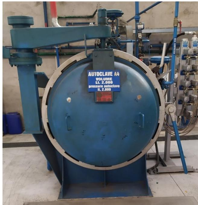
*Figura 1.3.3.1 Autoclave utilizzata per i cicli proposti*
