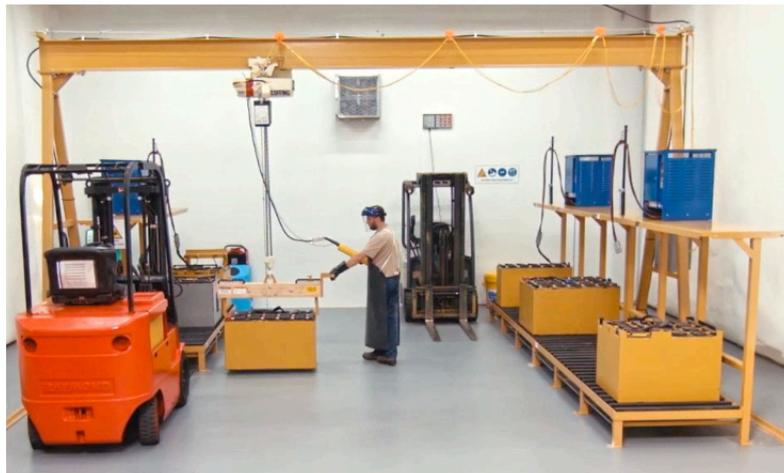
*Figura 1 – Esempio di area dedicata alla sostituzione e ricarica batterie [16]*
