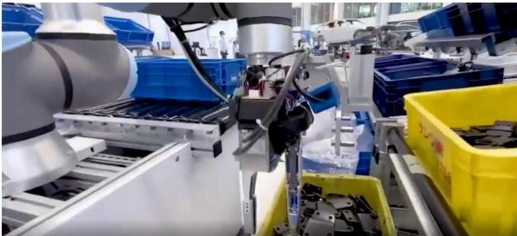
FIGURA 42 - SISTEMA DI VISORE MONTATO SUL UR3
