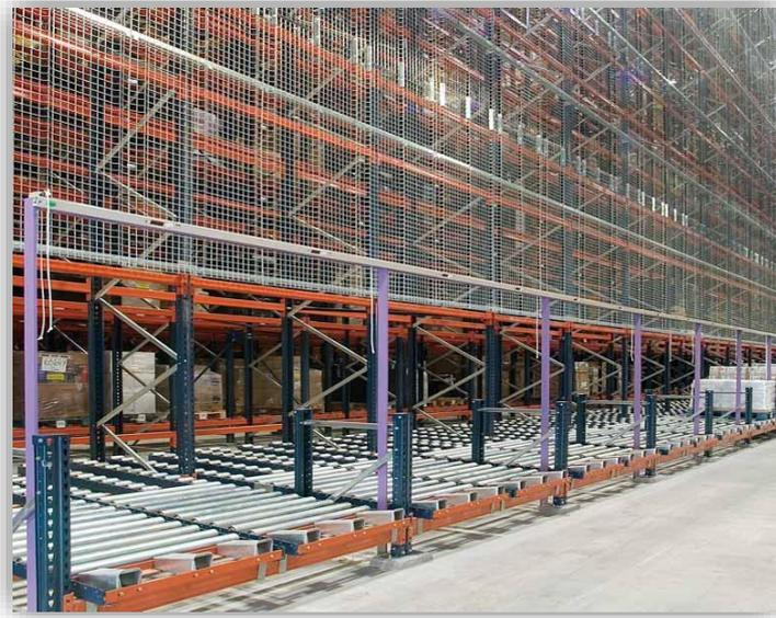
FIGURA 7 - POSTAZIONE DI PICKING SU PALLET INSTALLATA NELLA ZONA LATERALE DEL MAGAZZINO AUTOMATICO
