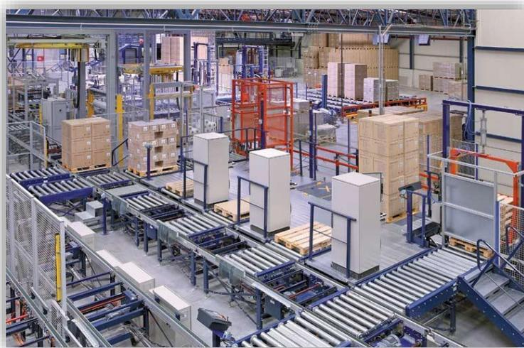
FIGURA 6 - POSTAZIONE DI PICKING INSTALLATA NELLA TESTATA DI UN MAGAZZINO AUTOMATICO
