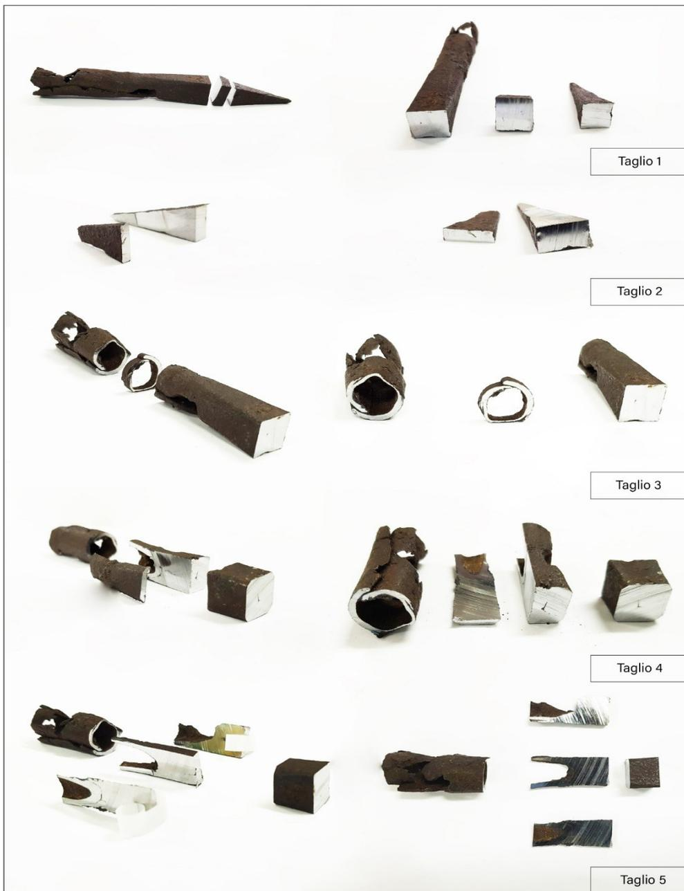
Figura 53 Fotografie del taglio della Punta II; Sono stati effettuati quattro tagli trasversali (Taglio 1, Taglio 3) e tre tagli longitudinali (Taglio 2, Taglio 4, Taglio 5) in prossimità di punta e gorbia.
