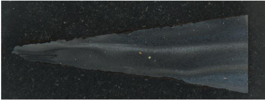
Figura 71 Macrografia della cuspide della punta II. Anche qui si possono intravedere strisce più chiare e più scure dovute alla differenza di grano cristallino e di carbonio.
