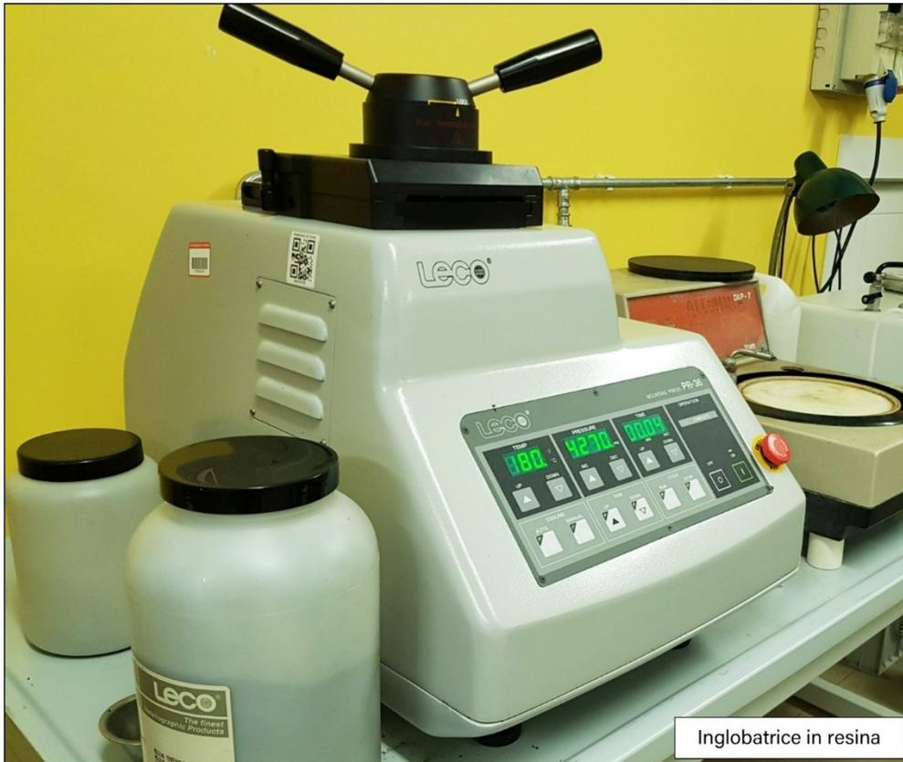
*Figura 57 Inglobatrice in resina utilizzata in laboratorio.*
