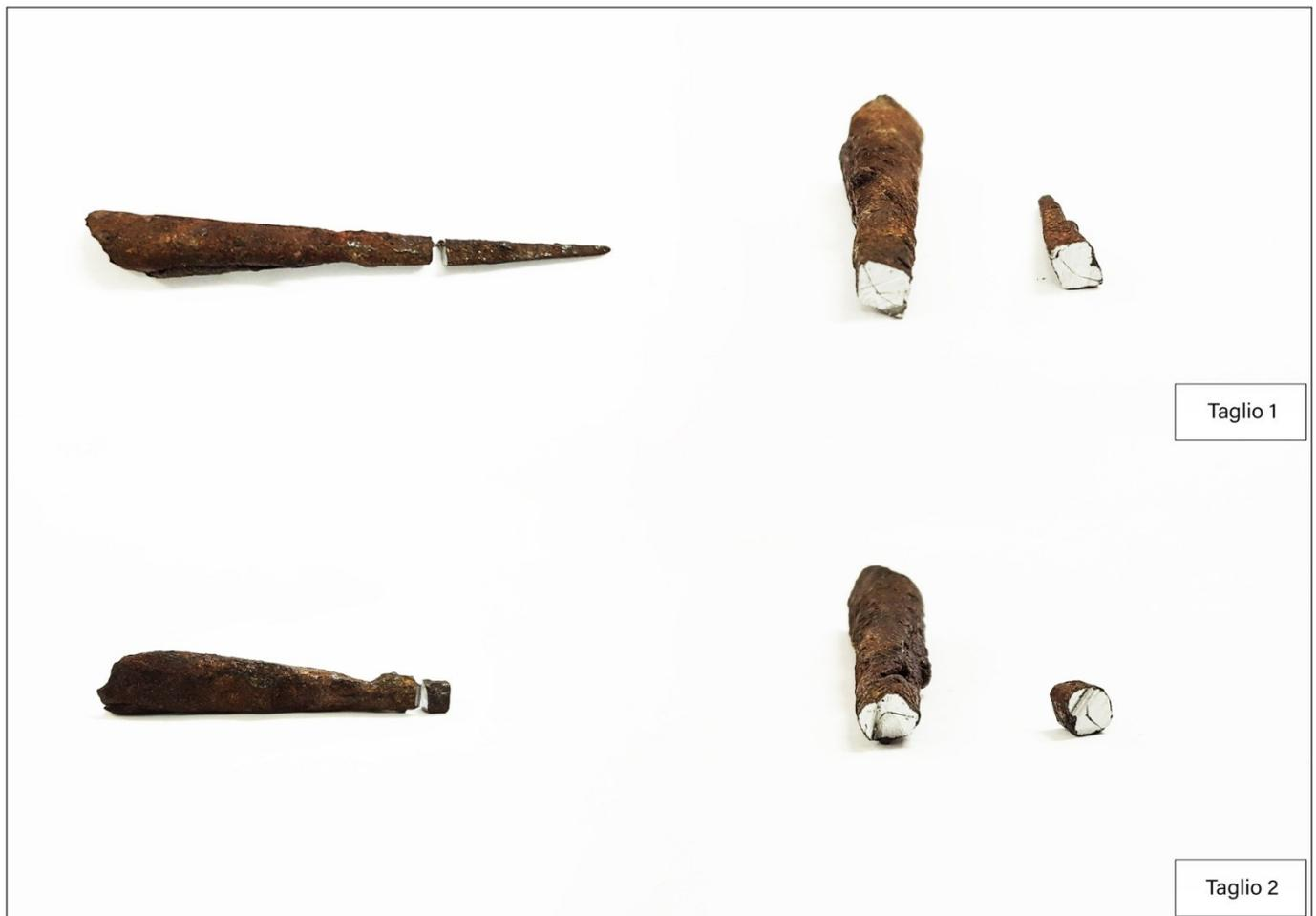
*Figura 52* Fotografie dei tagli effettuati sulla Punta I; Sono stati effettuati un taglio trasversale (Taglio 1) e un taglio longitudinale (Taglio 2) in prossimità della punta, zona di maggior interesse.
