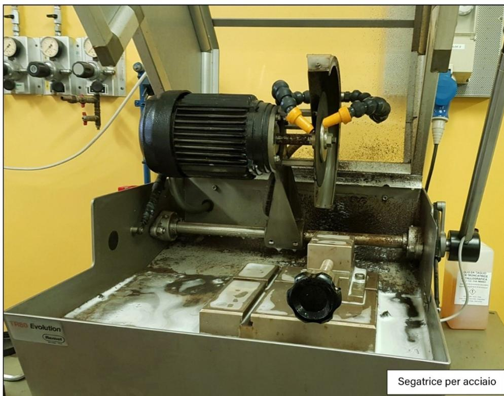
Figura 51 Macchina Utensile utilizzata per il taglio delle punte.
