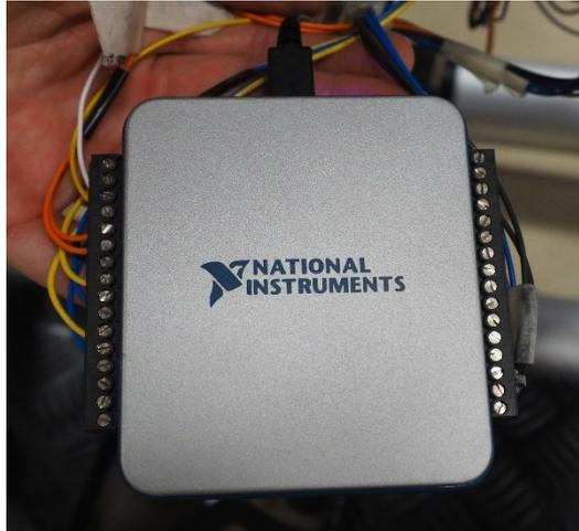
Figura 14: Scheda di acquisizione NI USB-6001
