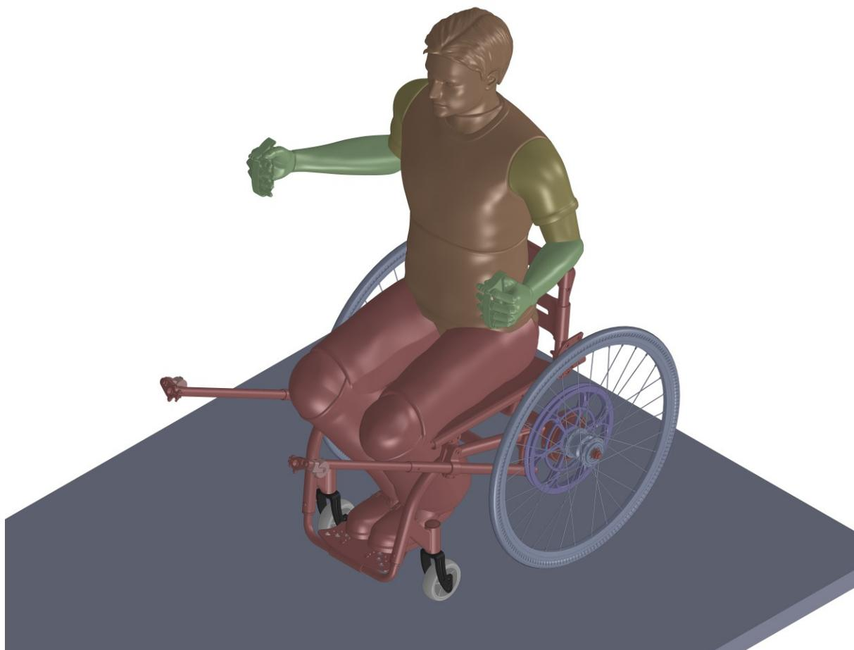
*Figura 41: Modello Handwheelchair.q completo di manichino*
