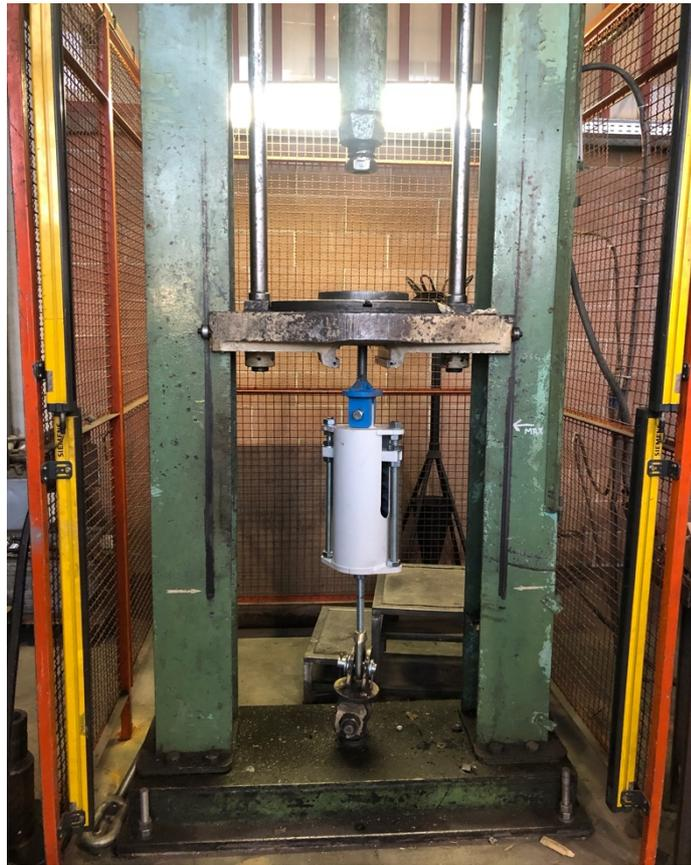
Figura 6.13: Simulazione di prova idrostatica SV2.320B
