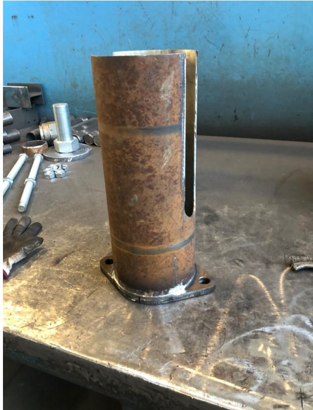
Figura 6.11: Saldatura corpo contenitore molla
