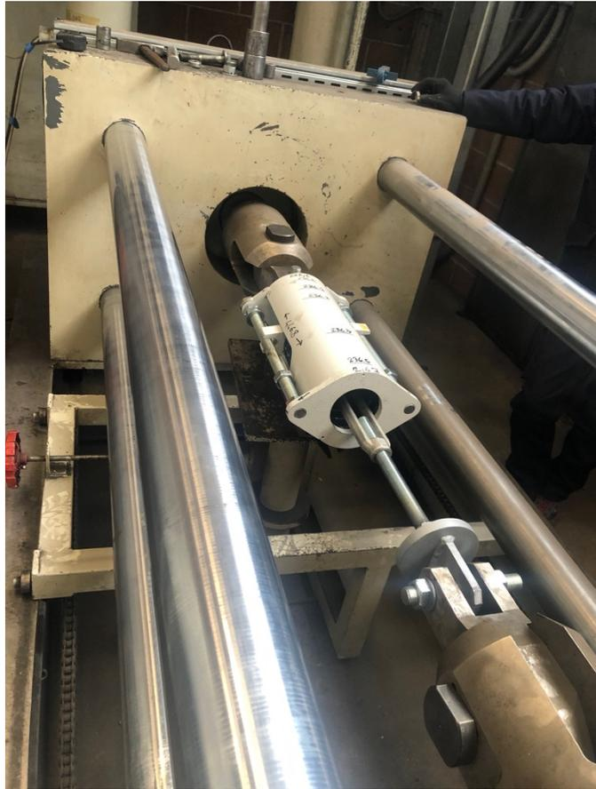
Figura 6.14: Simulazione carico ciclico SV2.320B
