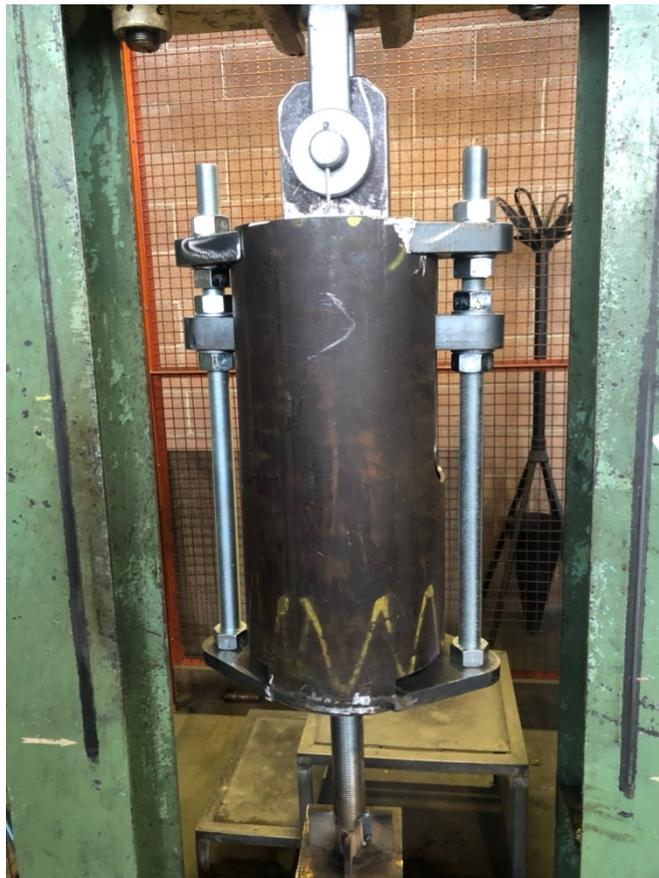
Figura 7.17: Prova idrostatica SV2.520B
